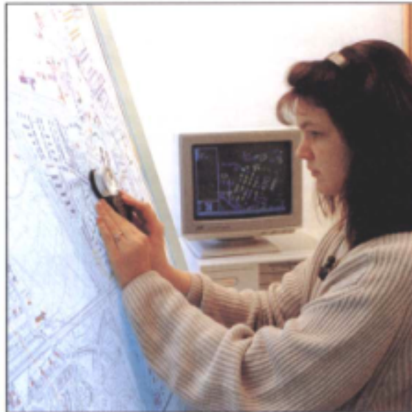
Bild 3: Lagerichtige Aufnahme der Modellelemente am Digitalisiertisch
