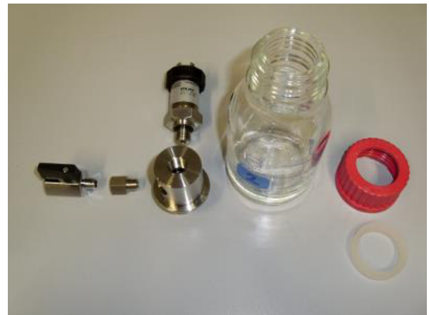
Bild 10: Links: Schematische Darstellung eines angeschlossenen Batchversuchs mit kontinuierlicher Druckaufzeichnung nach DIN EN ISO 11734 (Gasvolumenmessung mittels Gasdruckgerät) (VDI 4630, (2012)). Rechts: Kugelhahn mit Adapter für die Probenentnahme; Drucksonde zur Datenaufzeichnung, Probenflasche (in der Abbildung 250 ml), Schraubverschluss mit Gummidichtung
