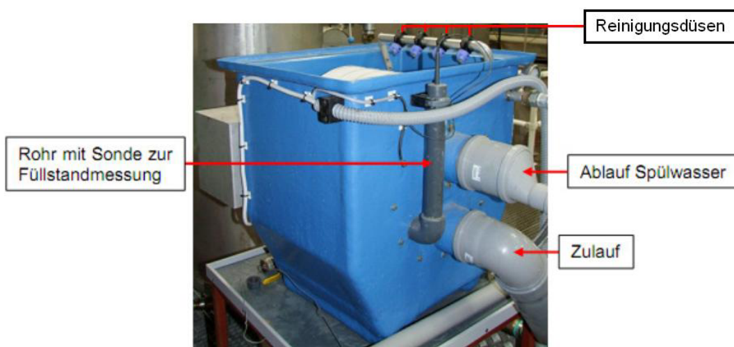
Abbildung 5.24: Funktionsweise des Mikrosiebs (Pinnekamp, 2012)
