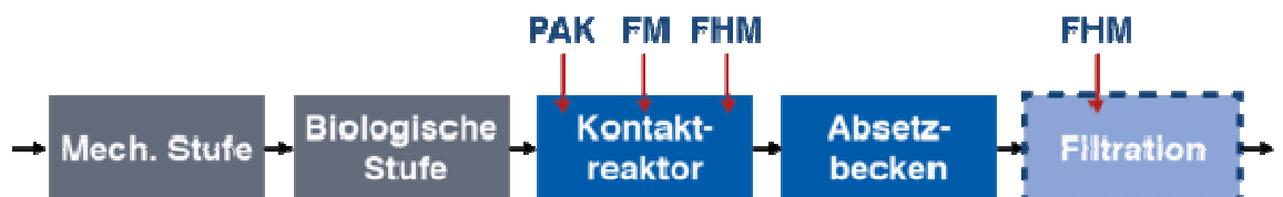
Abbildung: Schematische Darstellung der PAK-Dosierung in einer separaten Adsorptionsstufe
