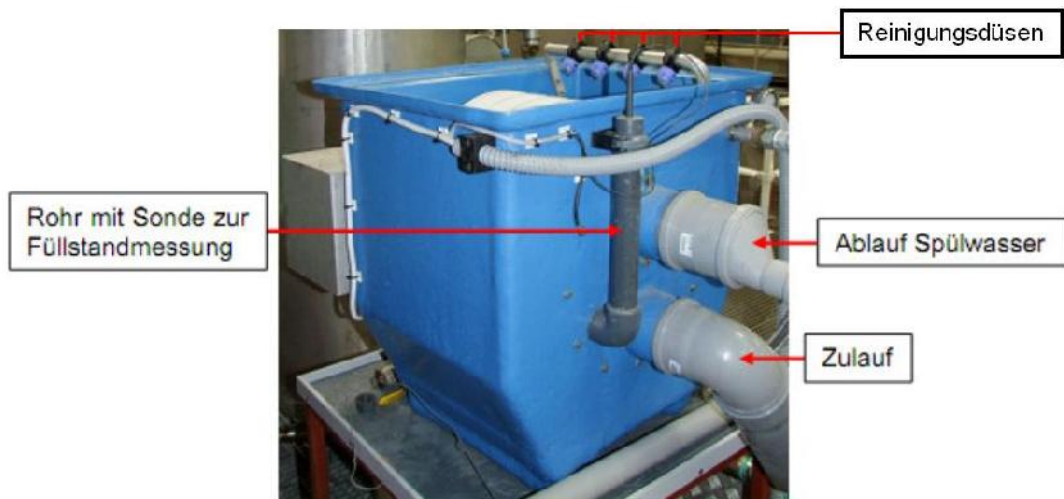
Abbildung 6.23: Mikrosiebanlage (verändert nach Pinnekamp, 2012)
