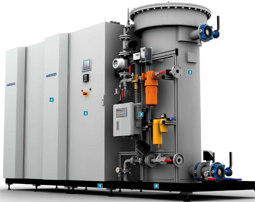
Bild 5-3: Ozongenerator, Stromversorgungseinheit und Verrohrung als Kompakteinheit (Firmenschrift Fa. Wedeco/Xylem)
