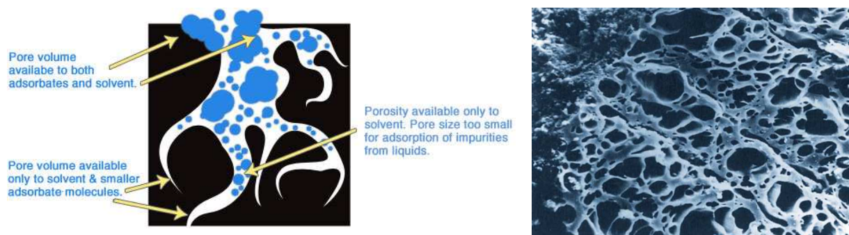
Bild 4.1: Schematische Darstellung oberflächennaher Schichten der A-Kohle und REM-Aufnahme der Oberfläche (Firmenschriften Norit und Donau Carbon)
