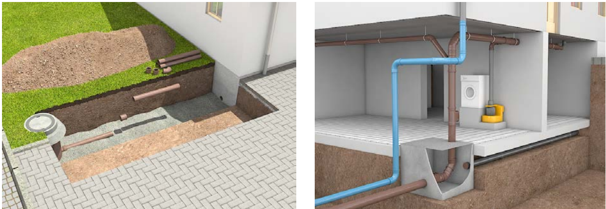
Bild 12: Verfahren zur Erneuerung (links: offene Bauweise, rechts: Installation von Rohren an Decken und Wänden)
