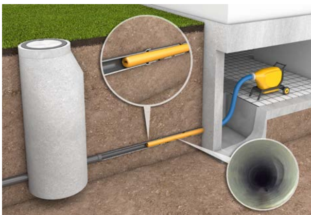
Bild 13: Renovierung durch Schlauchlining
