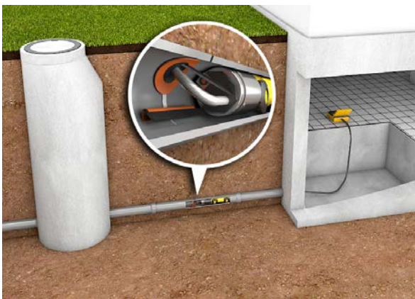
Bild 18: Verfahren zur Reparatur (links: Roboterfahren, rechts: Innenmanschette)
