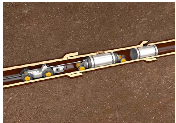
Bild 18: Verfahren zur Reparatur (links: Roboterfahren, rechts: Innenmanschette)
