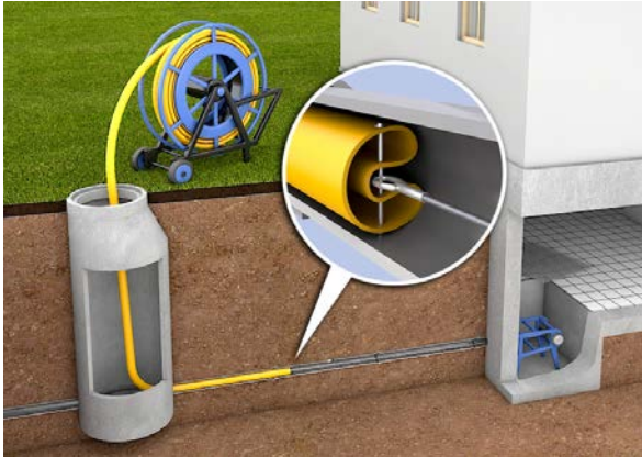
Bild 17: Renovierung durch Close-Fit Lining
