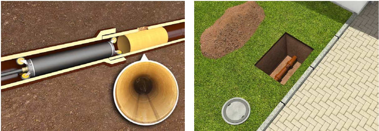
Bild 14: Verfahren zur Reparatur (links: Kurzlinier, rechts: Kleinbaugrube)
