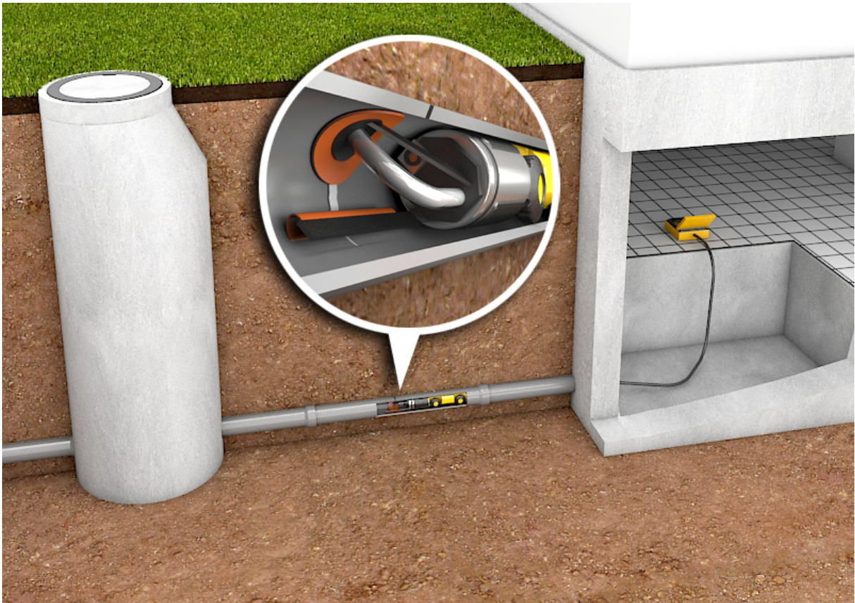
Bild 49: Reparatur durch Roboterverfahren, Beispielgrafik
