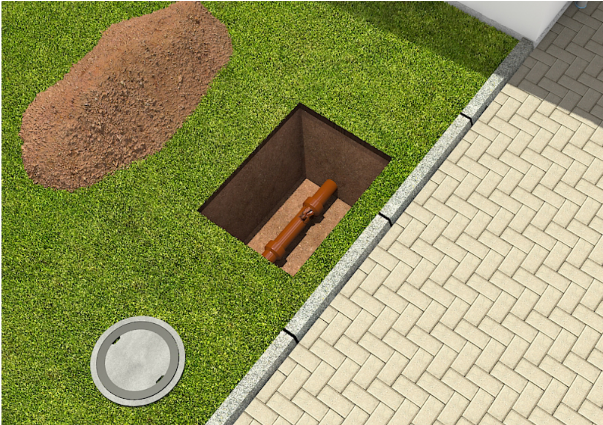
Bild 46: Reparatur durch Kleinbaugrube in offener Bauweise, Beispielgrafik
