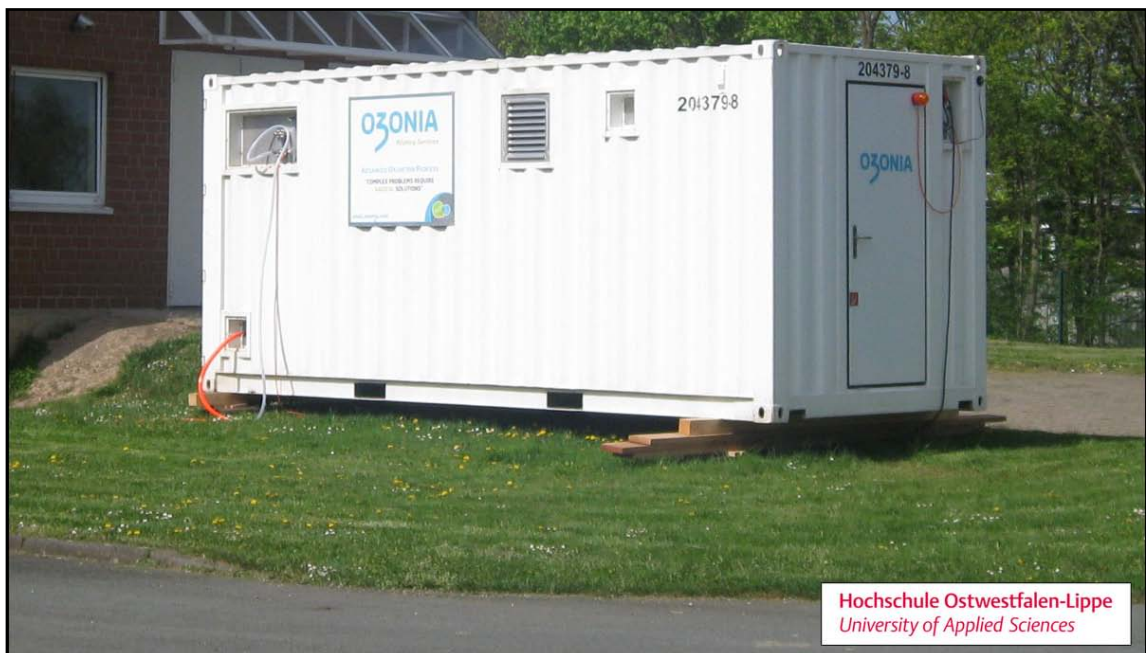
Abbildung 26: Halbtechnische Ozon-Versuchsanlage (Containerbauweise) der Fa. Ozonia - Degrémont Technologies Ltd, Dübendorf (CH) am Standort der ZKA Detmold
