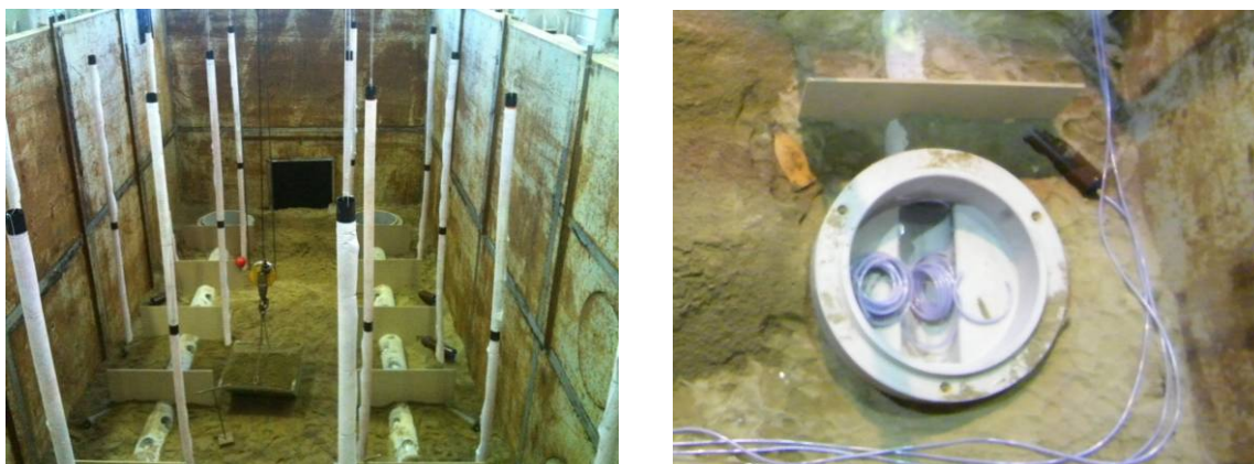
Bild 19 Versuchsaufbau nach Herstellung von Schadensbild 1 (links) und angeschlossene Entlüftungsschläuche an Rohren für Schaden 1 (rechts)
