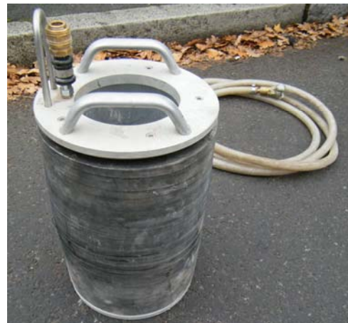
Bild 91 Für den Einbau vorbereitete Manschette (links) und Packer zum Aufstellen der Manschette im Kanal (rechts)
