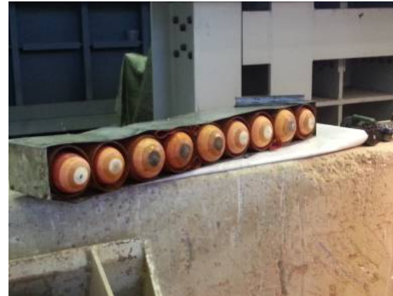
Bild 41 Roboter mit Absperrlement und Schalungsmanschette (links) sowie Vorratsbehälter mit weiteren Absperrlementen (rechts)
