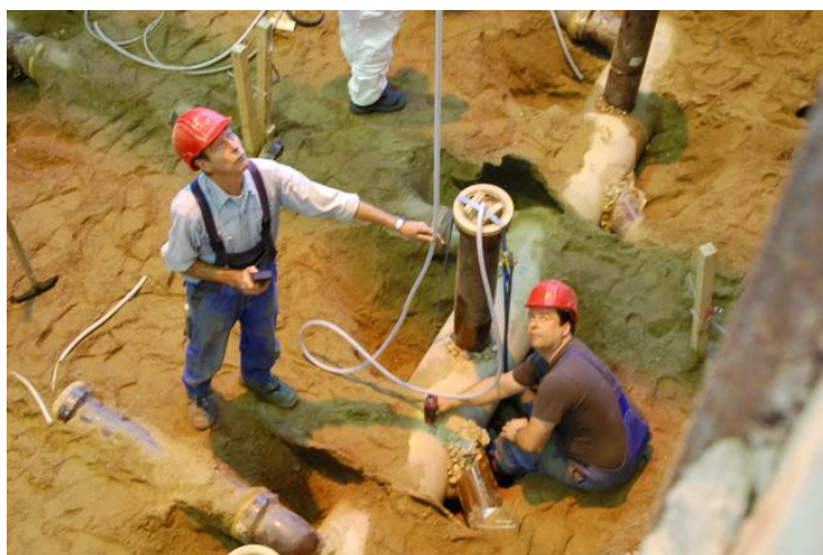
Bild 33 Dichtheitsprüfung an einzelnen Rohrabschnitten mit sanierten Stutzen: Kontrolle mittels TV-Kamera (links) und Einstellen der korrekten Druckhöhe (rechts)
