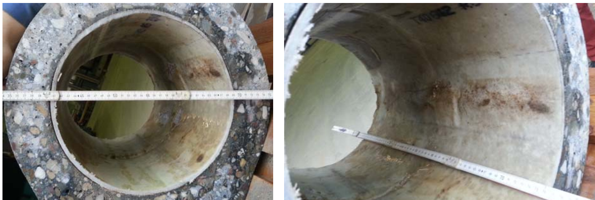
Bild 114 Rohrabschnitt mit Einbeulung mittig im rechten Kämpfer nach dem Heraussägen
