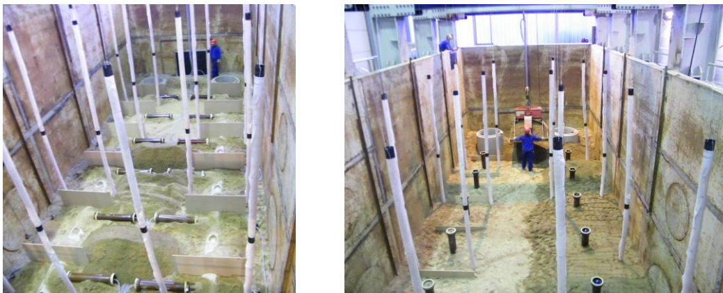
Bild 22 Versuchsaufbau nach Herstellung von Schaden 3 (links) und Auffüllen des Versuchstandes mit Kies-Sand nach Einbau der Schadensbilder 2 (rechts)
