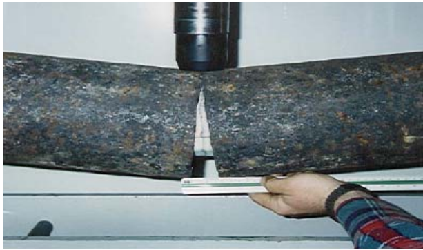
Bild 105 Auswinkelversuch bei Gewebeslauchrelining nach DVGW G 478 [48]
