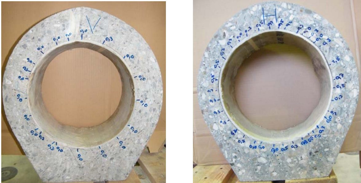
Bild 116 Vermessung der Ringspalte vor und hinter der Einbeulung
