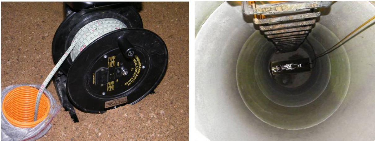
Bild 31 Messung des Wasserstandes mittels Lichtlot (links); Kamerabefahrung zur Erfassung des Zustandes der einzelnen Stutzen (rechts)
