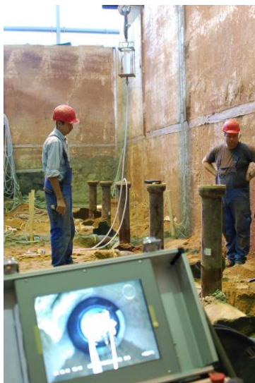
Bild 33 Dichtheitsprüfung an einzelnen Rohrabschnitten mit sanierten Stutzen: Kontrolle mittels TV-Kamera (links) und Einstellen der korrekten Druckhöhe (rechts)
