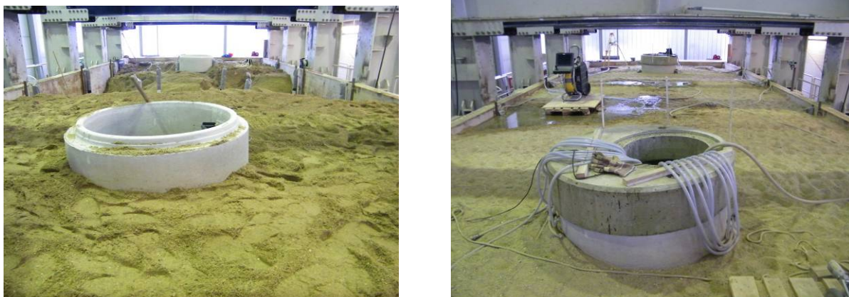
Bild 25 Großversuchsstand im Aufbau mit lagenweisem Einbringen des Bodens (links) und vollständig für die Untersuchungen hergestellt (rechts)
