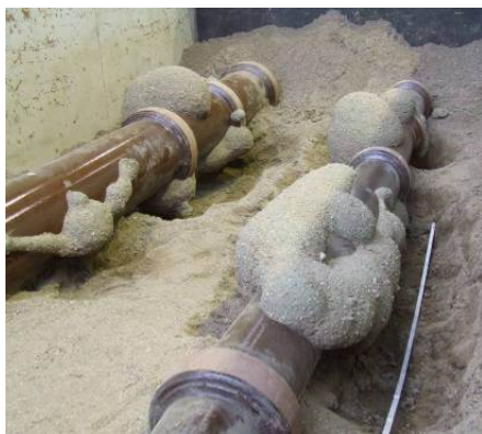
Bild 5 Freigelegter Injektionskörper in der IKT-Versuchshalle
