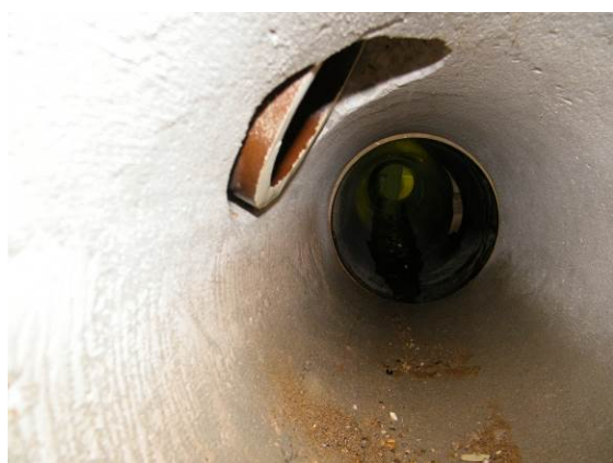
Bild 29 Schaden 3, Aufbau im Versuchsstand: einragender Steinzeug-Rohranschluss DN 150 in das Beton- (links) und Steinzeugrohr DN 300 (rechts)
