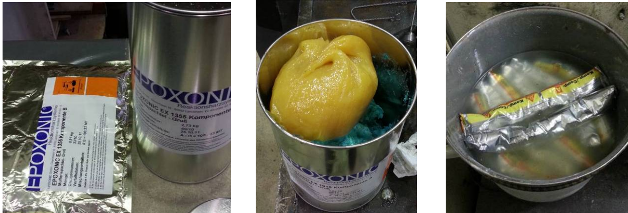
Bild 43 Gebinde mit den Komponenten A und B des Verpressmaterials (links) und Vorlegen beider Komponenten in einem Gefäß für nachfolgenden Rührvorgang (mittig), Konditionierung der Materialgebilde im Wasserbad für den Einsatz im Statkmischer (rechts)
