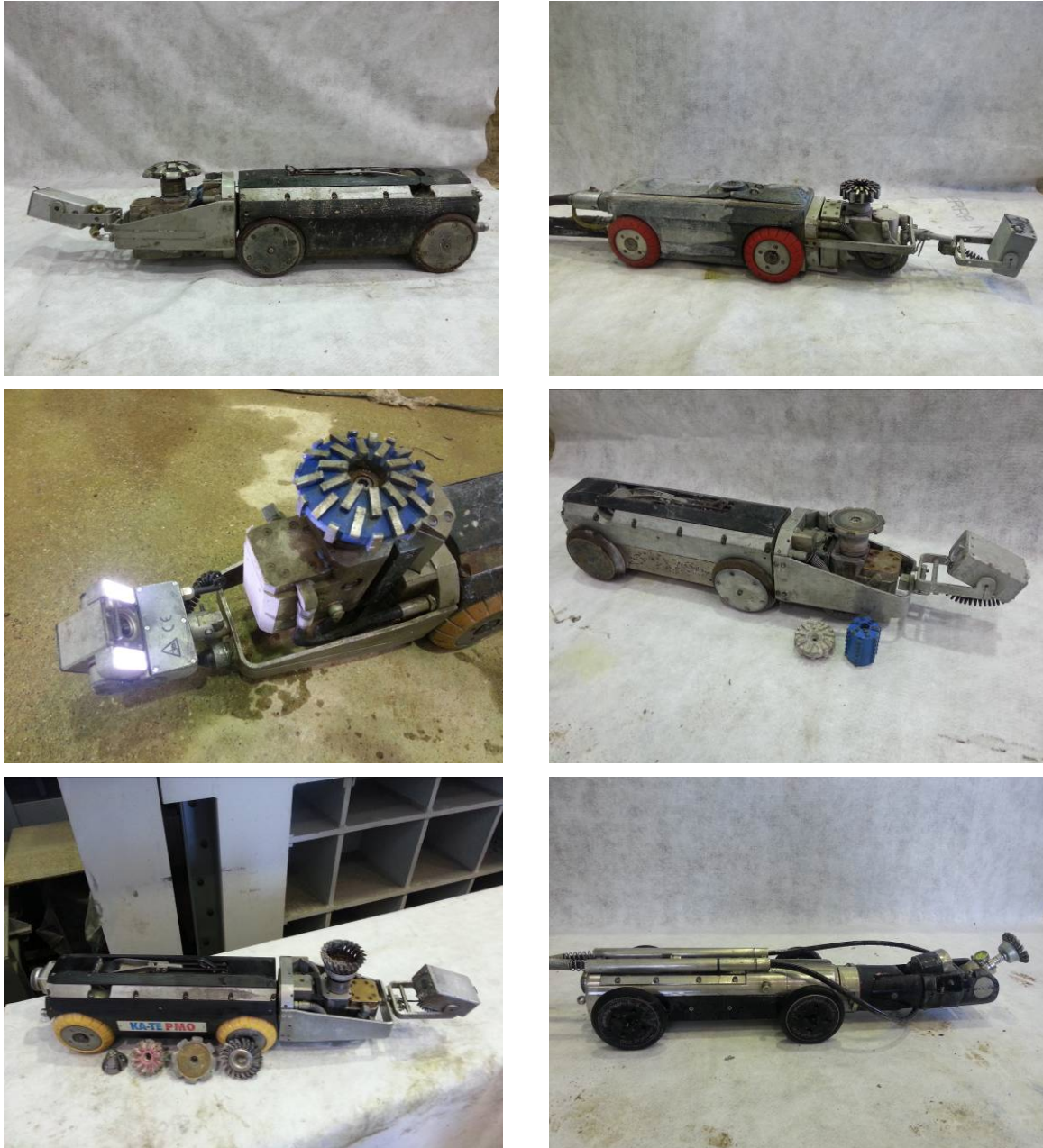
Bild 36 Eingesetzte Fräsroboter von KA-TE und IBG (nur rechts unten) nach Baujahr – ältestes Baujahr (links oben) und jüngstes Baujahr (rechts unten)
