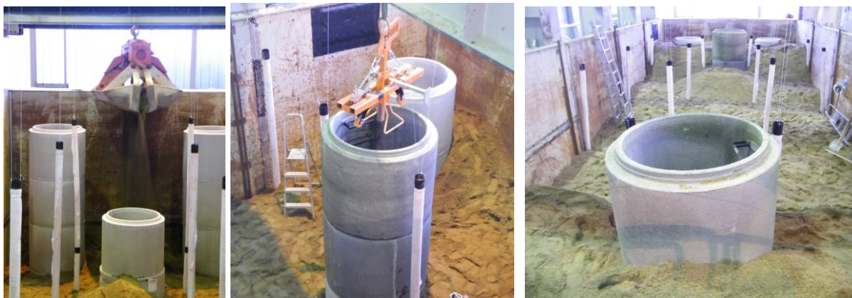
Bild 24 Fortschreitender Aufbau der Schächte und Auffüllen der Zwischenräume bzw. des Versuchsstandes mit Kies-Sand
