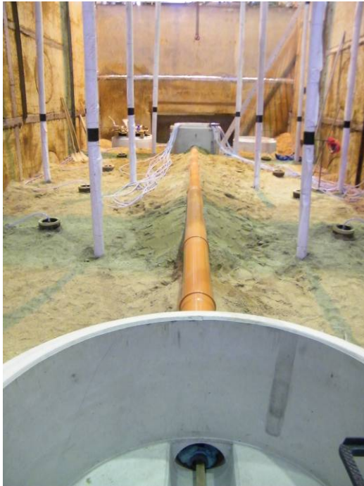
Bild 98 Einbau des Rohrstranges im Großversuchsstand, Höhenlage ca. 2,5 m
