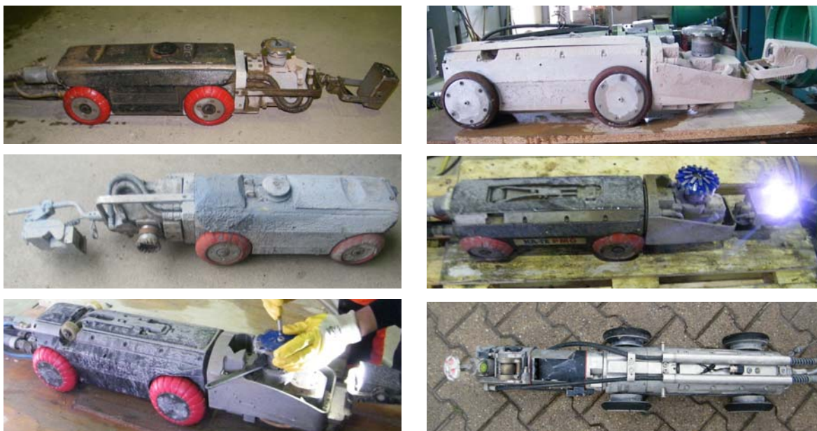
Bild 55 Eingesetzte Fräsroboter von KA-TE, ProKASRO und IBG ( beide in der unteren Zeile) nach Baujahr – ältestes Baujahr (links oben) und jüngstes Baujahr (rechts unten)
