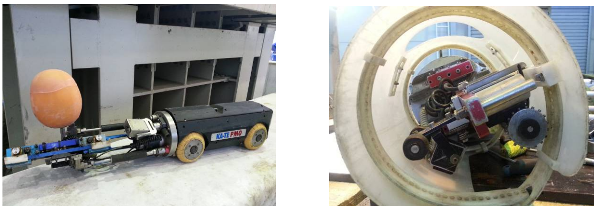
Bild 40 Roboter mit aufgeblasenem Absperrelement (links) und Schalungsmanschette einschließlich Setzgerät (rechts)
