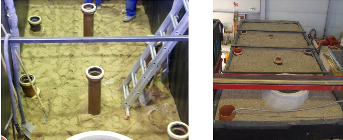
Bild 30 Eingebaute Hausanschlüsse DN 150 mit Sand umgeben (links) und vollständig aufgebauter Versuchsstand (rechts)
