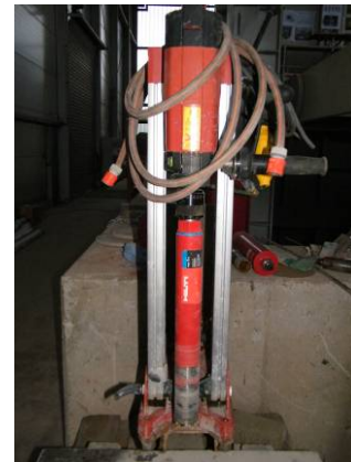
Bild 8 Lochkranz aus acht einzelnen Kernbohrungen (links) und Kernbohrmaschine (rechts)
