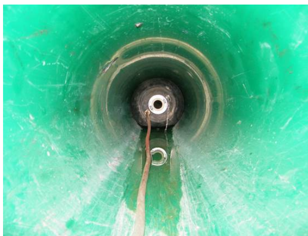
Bild 35 Freigelegte Haltung (links), Begrenzung des Prüfraumes im Hauptkanal durch Absperrblasen (rechts)
