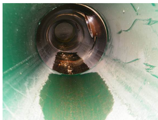
Bild 29 Schaden 3, Aufbau im Versuchsstand: einragender Steinzeug-Rohranschluss DN 150 in das Beton- (links) und Steinzeugrohr DN 300 (rechts)
