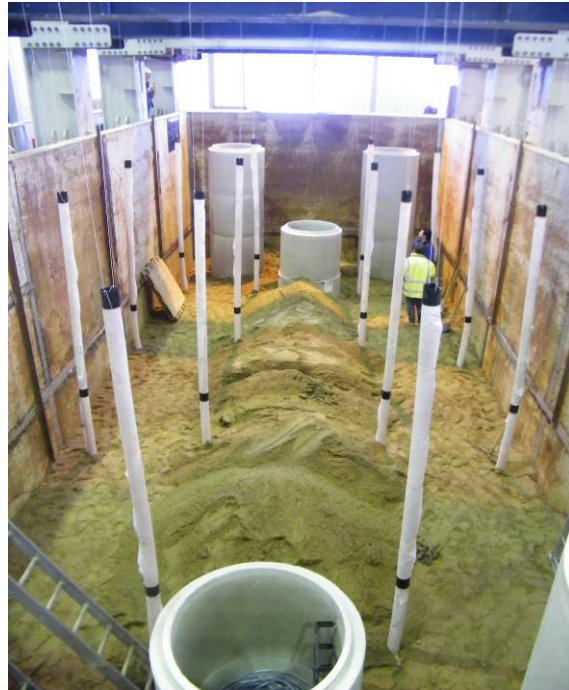
Bild 98 Einbau des Rohrstranges im Großversuchsstand, Höhenlage ca. 2,5 m
