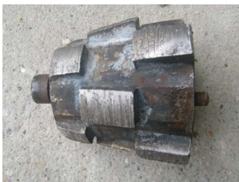
Bild 56 Beispiel für einen im Rahmen dieser Versuche bisher nicht eingesetzten Trapezfräser
