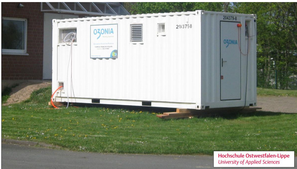
Abbildung 23: Halbtechnische Ozon-Versuchsanlage (Containerbauweise) der Fa. Ozonia – Degrémont Technologies Ltd, Dübendorf (CH) am Standort der ZKA Detmold
