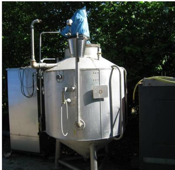
**Bild 3.5: Faulgasbehälter für die halbtechnischen Versuche**
