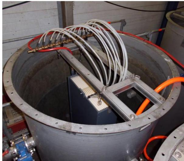
**Bild 3.4: Blick in die Nitrifikation/ Membranfiltration**
