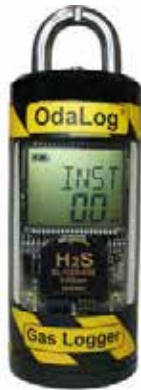
Abbildung 90: Verwendeter Gaslogger zur Onlineaufzeichnung der Schwefelwasserstoffkonzentration in der Abluft AppTek (A1-CBISS, 2011)
