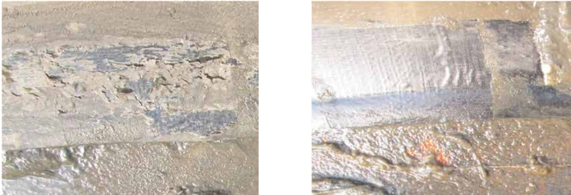
Abbildung 49: Links: Ablagerungen am Rand des Versuchsrohrs nach ca. einem Tag ohne Beschickung. Rechts: Identische Stelle im Versuchsrohr einen Tag später. Die bisherige Sielhaut ist vollständig verschwunden
