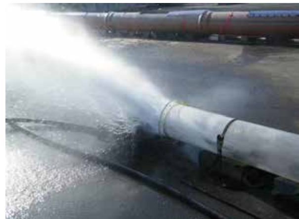
Abbildung 133: Druck- und Durchflussmessung im Düsenbetrieb, „Fahrzeug-Check“
