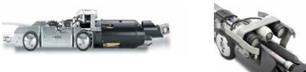
Abbildung 13: TV-Inspektionskamerawagen (Bundesministerium für Verkehr, Bau und Stadtentwicklung, 2011)
