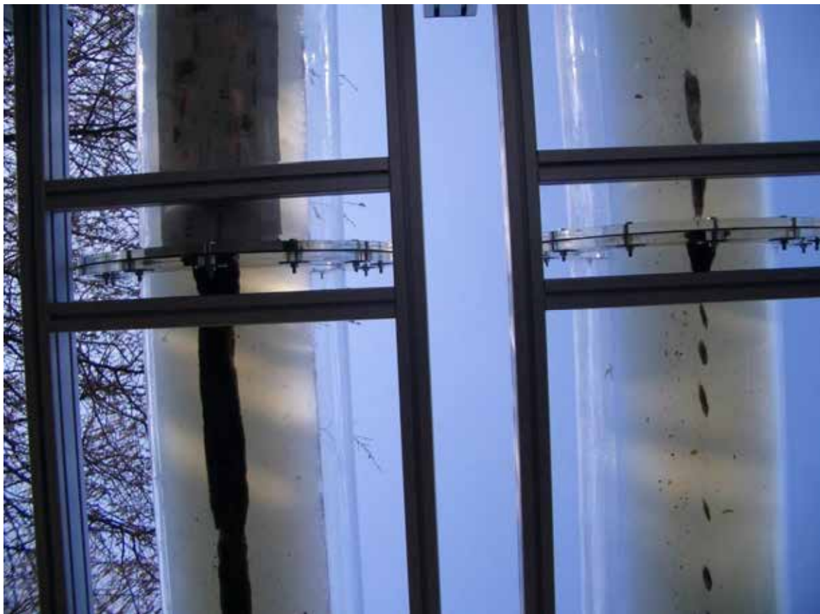
Abbildung 52: Ablagerungsbildung mit (links) und ohne (rechts) Sandpapier bei ansonsten gleichen Randbedingungen ( Q=2 L/s, I_S=1 ‰), Fließrichtung von unten nach oben
