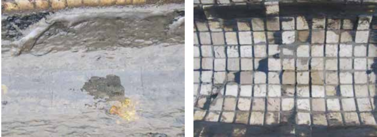
Abbildung 66: Links: Deutliches Biofilmwachstum Mitte Oktober sowie in Folge des Biofilm auch vermehrtes Auftreten von Ablagerungen. Rechts: Kaum Biofilmwachstum in den Wintermonaten. Im Vergleich zu den Sommermonaten ist nur ein dünner Sedimentfilm am Rand zu erkennen.
