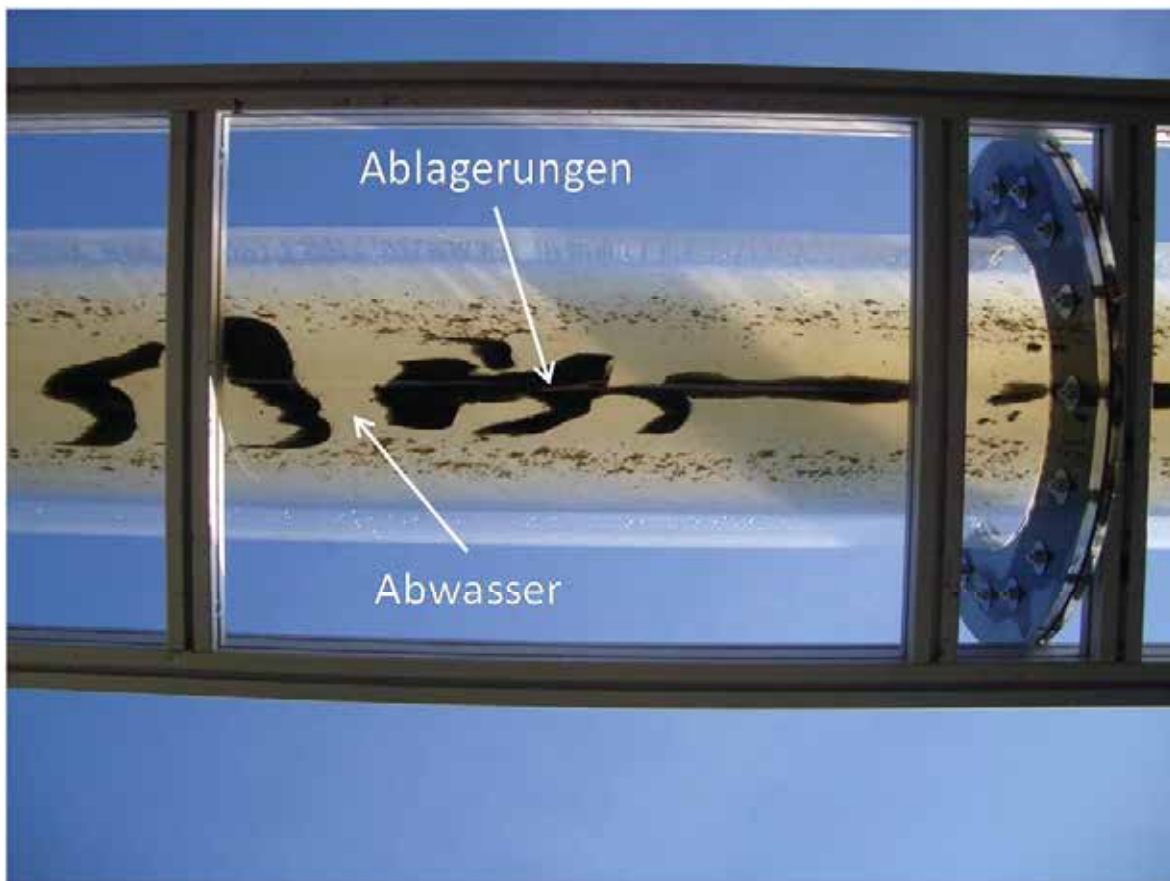
Abbildung 50: Ablagerungsbildung in einem glatten Plexiglasrohr nach einem Tag ( Q=2 L/s I_s=1 ‰, k_s\approx 0,0015 mm), von unten aufgenommen
