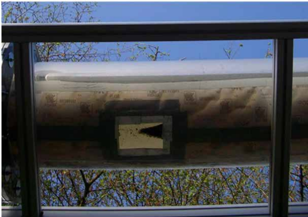
Abbildung 69: Versuchrohr mit Anpassung im Schleifpapier
