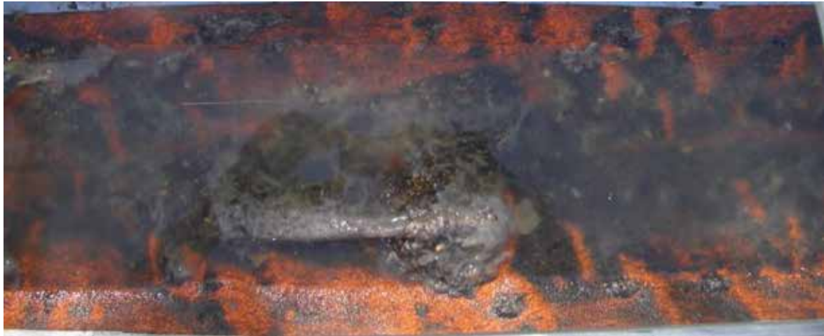
Abbildung 51: Ablagerungen auf Sandpapier nach zwei Tagen ( Q=2 L/s, I_S=1 ‰, k_S=0,4 mm, \tau=0,3 N/m 2 )
