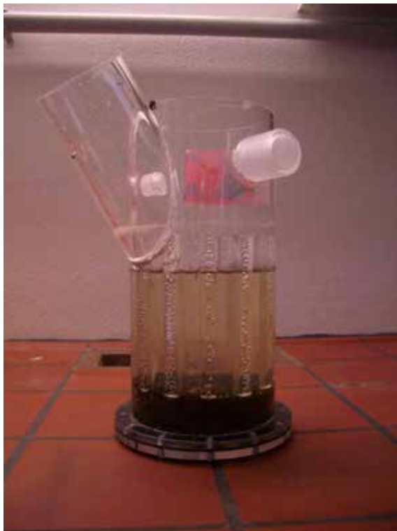
Abbildung 75: Plexiglasbehälter zur Messung des Erosionswiderstandes von Sedimenten
