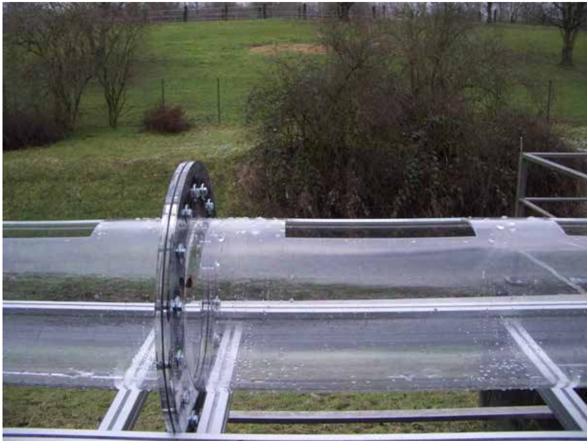
Abbildung 33: Plexiglasrohr mit Ausschnitten im Scheitel
