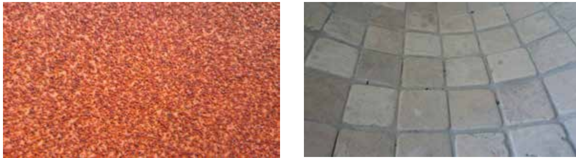
Abbildung 47: Links: Sandpapier mit einer Körnung von 40. Rechts: Verfugte Natursteinfliese. Mit dem Maß einer einzelnen Fliese von etwa 22 x 22 x 4 mm. Das Fugenmaß schwankte zwischen ein bis fünf Millimeter
