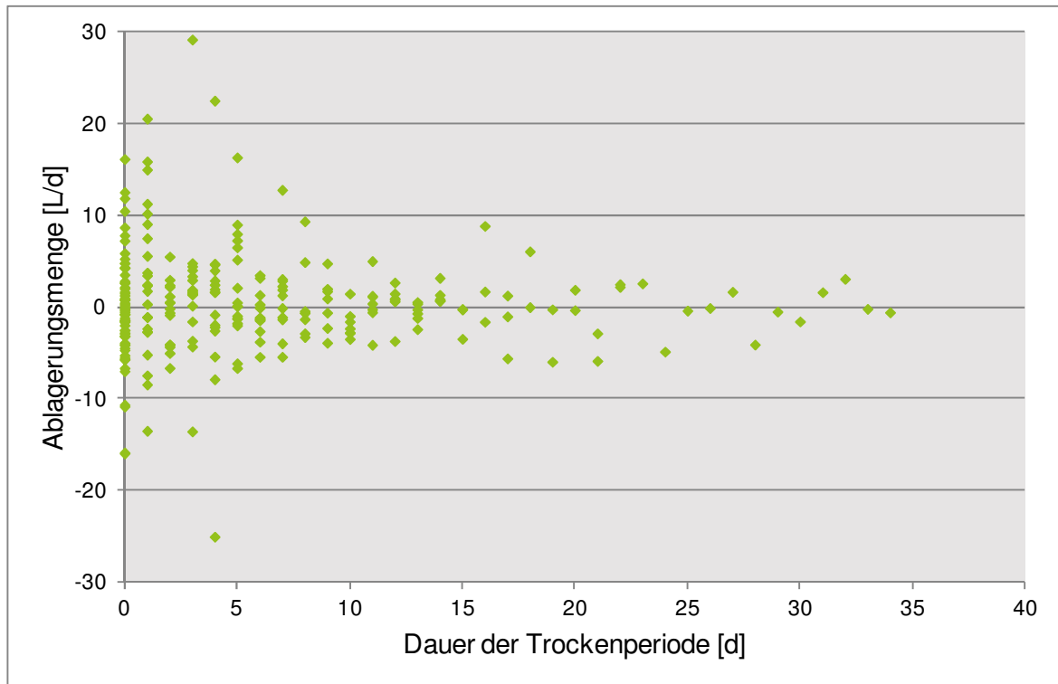
Abbildung 68: Tägliche Änderung aller Ablagerungen im Testrohr in Abhängigkeit von der Dauer der Trockenperiode (Versuchsreihen 11, 13, 14, 16, 17 und 20, Q=2 L/s, I_S=1 ‰, k_S=0,4 mm)
