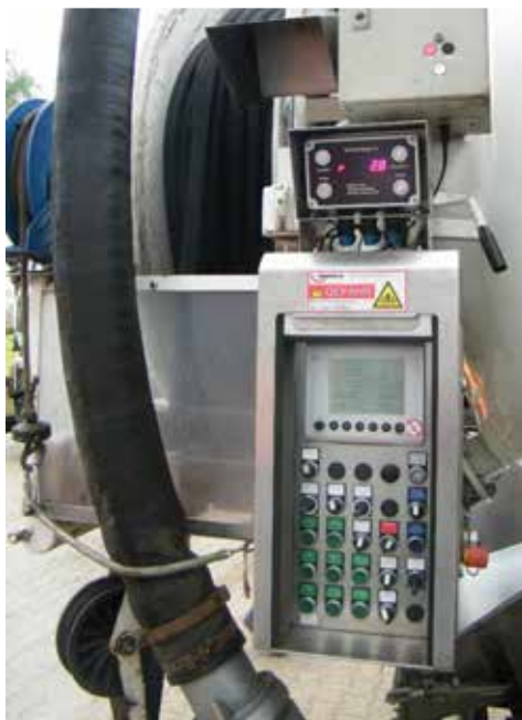
Abbildung 117: Aufzeichnung der Reinigungsdaten am Spülfahrzeug
