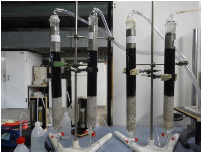
Abbildung 13: Versuchsaufbau der TUM: weitergehende Untersuchungen im halbtechnischen Maßstab
