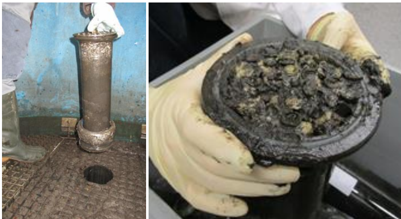
Abbildung 49: Standort Wuppertal – Entnahme der Feldsäulen aus dem Filterkörper zur weitergehenden Untersuchung im Labor (Abb. links), Unterseite der Feldsäule I mit sehr starken Verschmutzungen (Abb. rechts).
