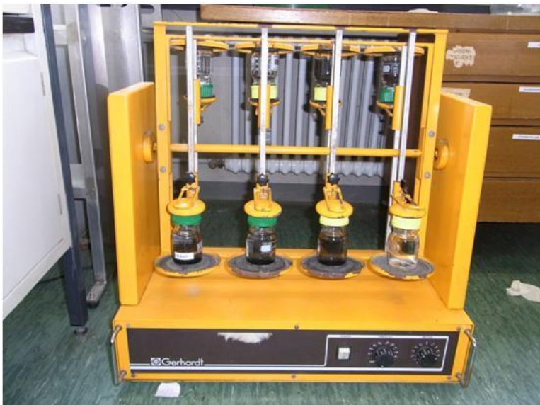
Abbildung 10: Für die Versuche eingesetzter Überkopfschüttler
