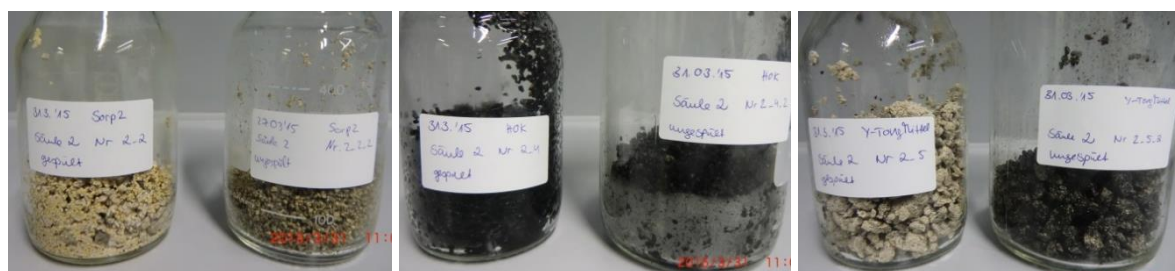
Abbildung 102: Gespülte und ungespülte Filtermaterialien, Sorp2 (links), Braunkohlekoks (Mitte) und FM_fein_unten (rechts), Standort Wuppertal
