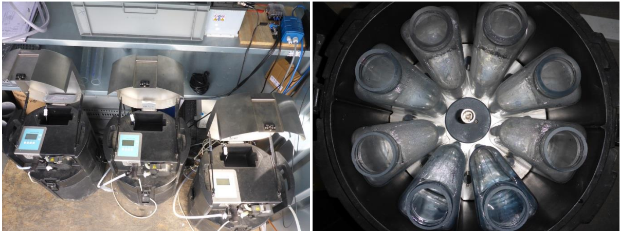
Abbildung 115: Probenehmer für Zulauf-, Filter- und Ablaufproben (v. r. n. l.)
