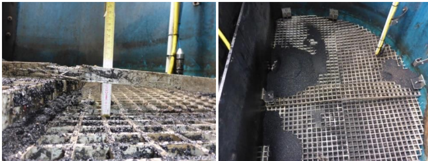
Abbildung 86: Gebrochene Traverse und ausgetragene Aktivkohle
