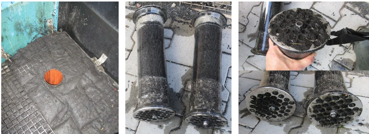
Abbildung 52: Standort Mönchengladbach: Einbauort der entnommenen Feldsäulen (links), Feldsäulen des Standorts Mönchengladbach (Mitte), Ober- und Unterseiten der Feldsäulen mit Verschmutzungen (rechts).
