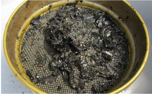
Abbildung 95: Abgesiebte Korngrößenfraktion größer 2 mm (Schachtsedimentprobe 2)
