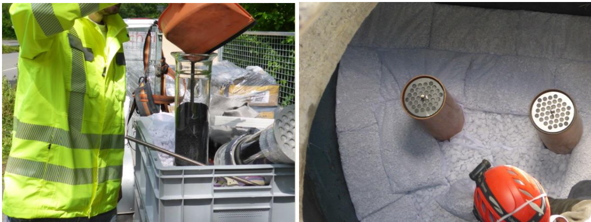
Abbildung 70: Probekörper für nachfolgende Laboranalysen (Ronsdorfer Straße in Wuppertal)
