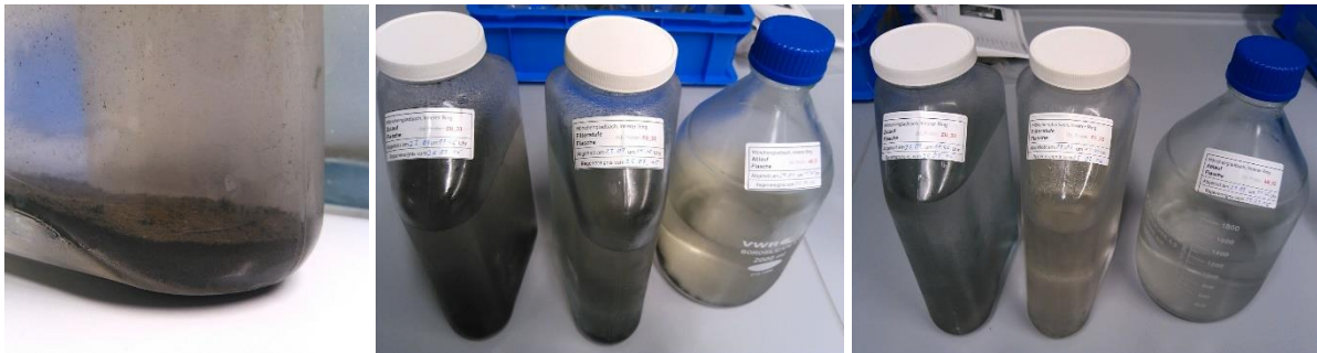
Abbildung 124: Proben des Regenereignisses vom 25.07.2015 – Feststoffe in der Zulaufprobe (links) und die zwei Probensätze des Anlagenzulaufs, des Ablaufs der Sedimentationsstufe (Mitte) sowie des Ablaufs der Filterstufe (rechts)
