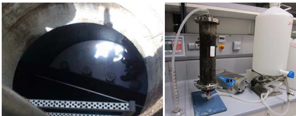
Abbildung 16: Einbau der Feldsäulen in den Filterkörper am Standort Wuppertal (links), Versuchsaufbau zur weitergehenden Untersuchung der Feldsäulen im Labor (rechts).
