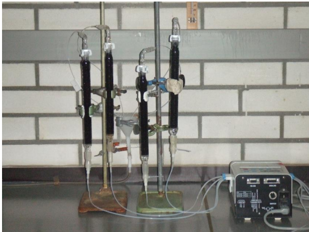
Abbildung 12: Versuchsaufbau der TUM: Bestimmung der Sorptionskapazitäten [Li, 2012]
