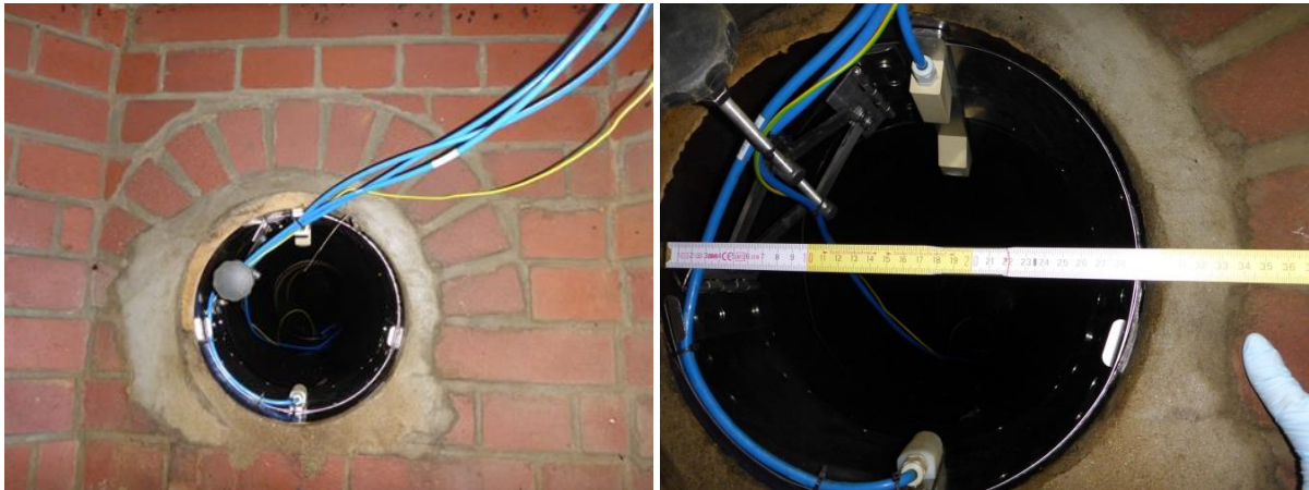
Abbildung 81: Durchflussmessung mit Höhenstands- und Fließgeschwindigkeitsmessung
