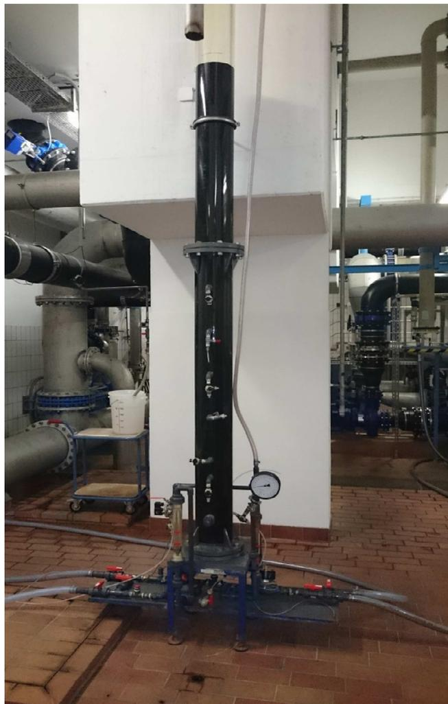
**Abbildung 6:** Aufstellung der Filtersäule (Kleinadsorber, AK) im Filtergebäude
