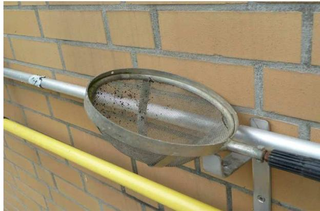
**Abbildung 32:** Schöpfesieb zur Prüfung des GAK-Gehalts im abgeleiteten Spülwasser an der Überlaufkante zur Spülwasserrinne
