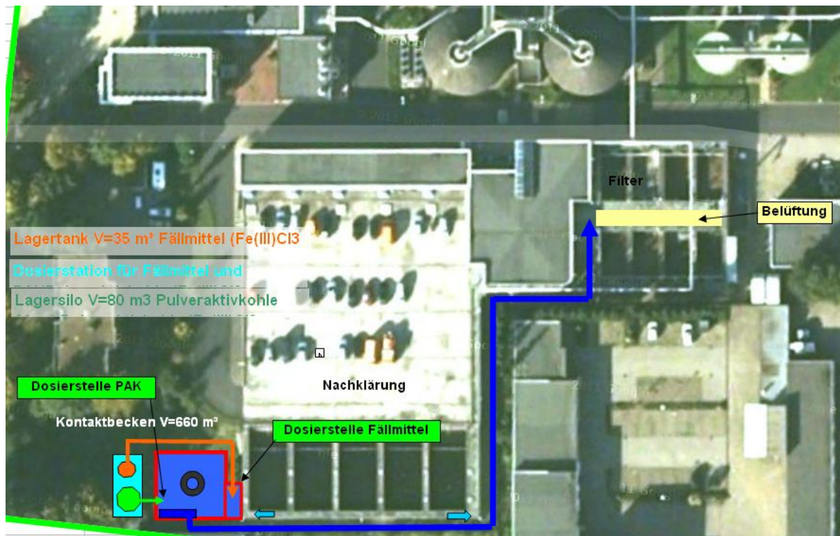
Abbildung 5-8: Übersichtslageplan PAK-Dosierung im Bypass vor dem Filter
