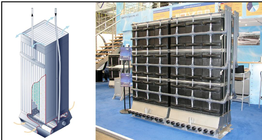
**Bild 2-7: Membranmodul der Martin Systems AG (links: Schematische Darstellung des Funktionsprinzips; rechts: anschlussfähiges Modulpaket) (PINNEKAMP und FRIEDRICH, 2006)**
