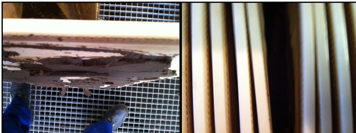
**Bild 3-15: Verblockte Membranplatten - Zwischenräume komplett mit Biomasse zugesezt**
