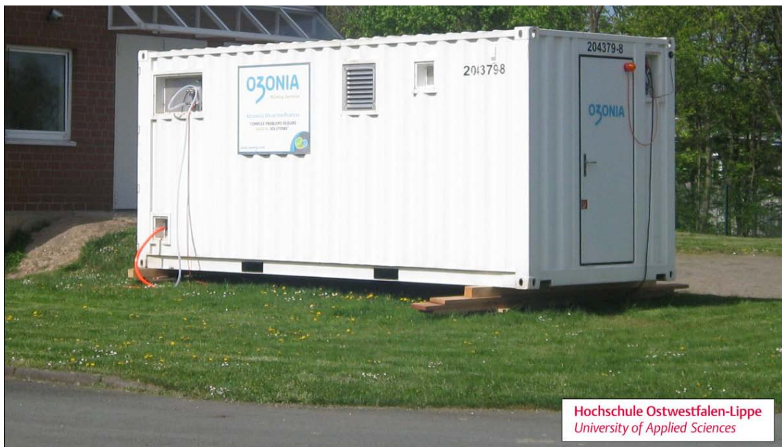
Abbildung 22: Halbtechnische Ozon-Versuchsanlage (Containerbauweise) der Fa. Ozonia – Degrémont Technologies Ltd, Dübendorf (CH) am Standort der ZKA Detmold
