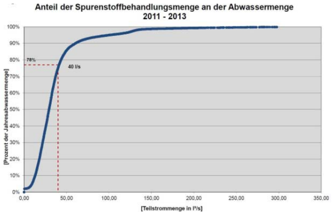
Abbildung 1: Auswertung Anteil der behandelten Teilstrommenge an der Ablaufmenge zur Spurenstoffanlage der KA Brock 2011 - 2013
