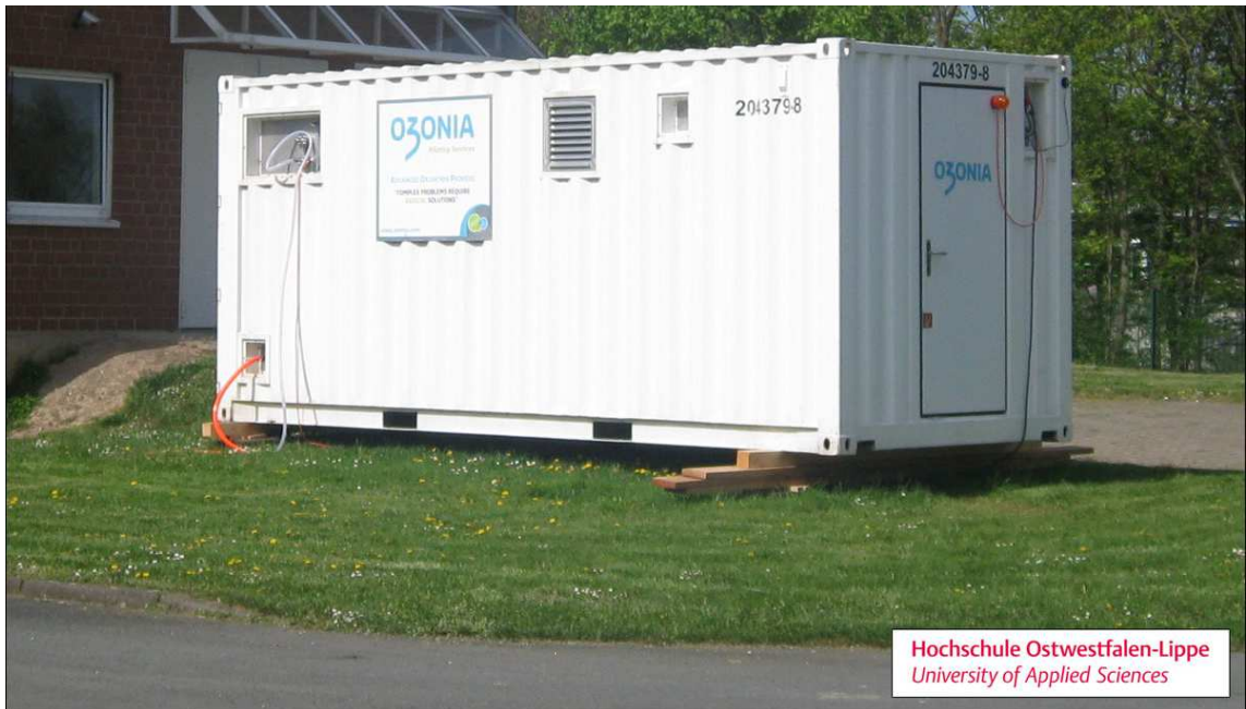
Abbildung 21: Halbtechnische Ozon-Versuchsanlage (Containerbauweise) der Fa. Ozonia – Degrémont Technologies Ltd, Dübendorf (CH) am Standort der ZKA Detmold
