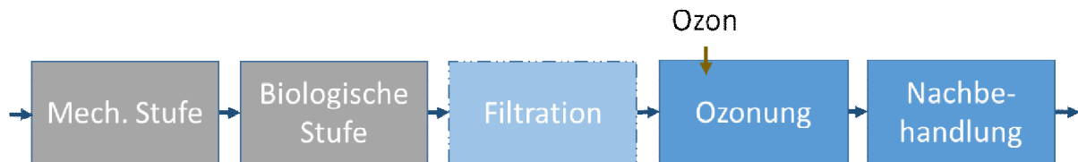
Abbildung 3-2: Schematische Darstellung der Einbindung einer Ozonung in den bestehenden Klärprozess [KOM-M.NRW, 2015]
