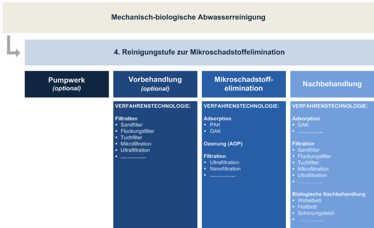
Abbildung 3-1: Verfahrensschritte zur Mikroschadstoffelimination
