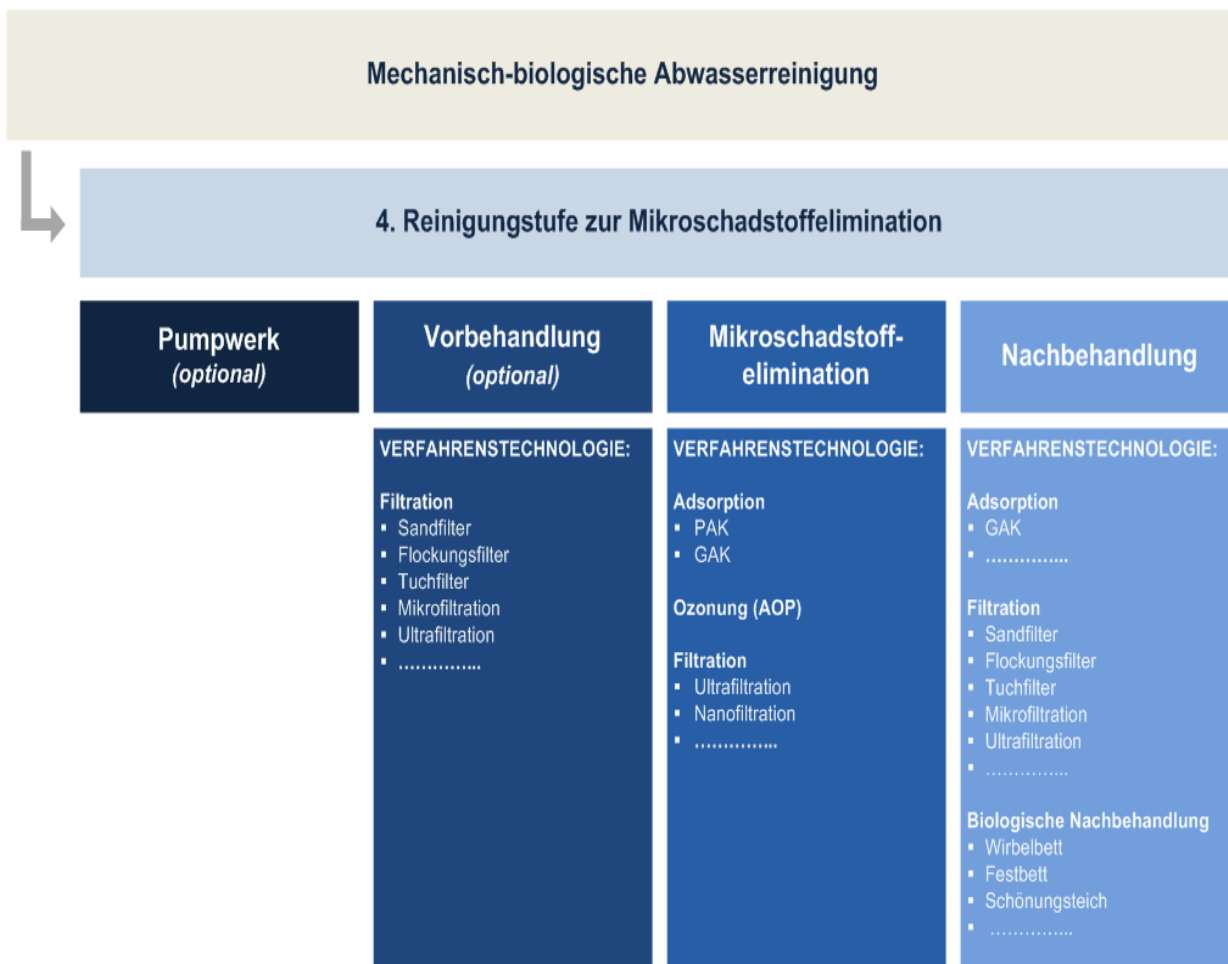
Abbildung 3-1: Verfahrensschritte zur Mikroschadstoffelimination
