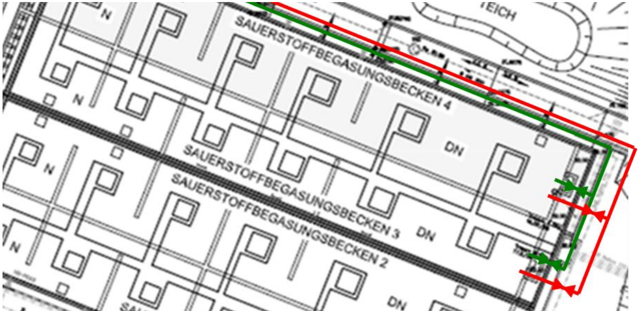
Abbildung 4-3: Zulauf zur Ozonanlage mit Absperrschieber
