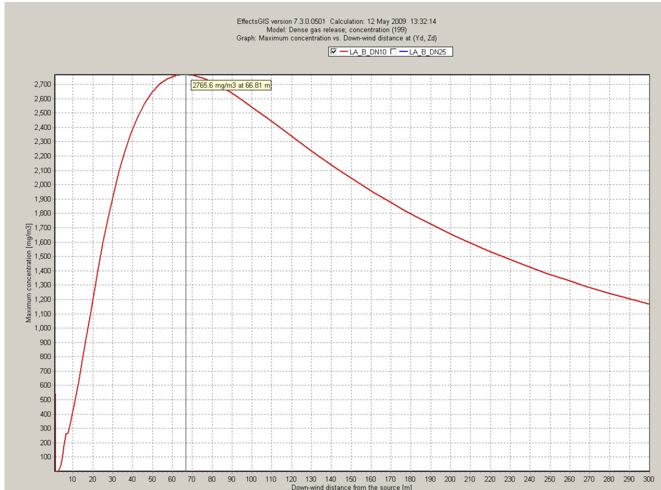
Diagramm A4.3-1: CO 2 -Konzentrationsprofil in Atemhöhe 1,5 m bei Stutzenabriss DN10 (Markierung = max. Konzentration)
