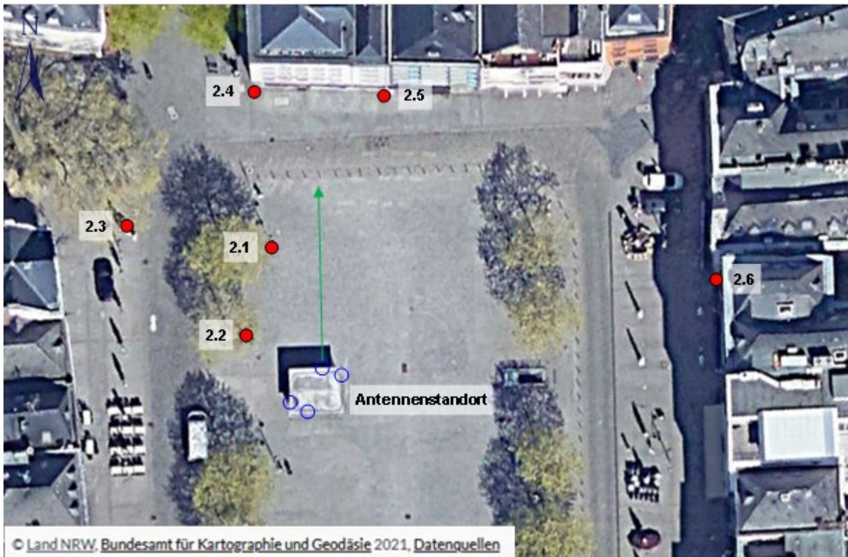
Abbildung 4.5: Standort 2: Umgebungsplan mit Antennenstandorten (blaue Kreise) und Lage der Messpunkte. Die grüne Linie beschreibt Verlauf und Ausdehnung der Linienmessung.
