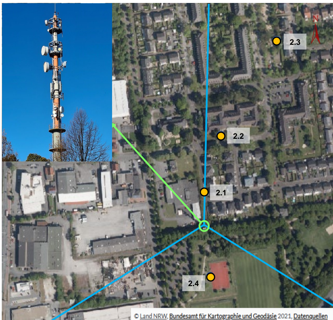
Abbildung 3.2: Ausrichtung der 5G-Sendeannten und Lage der Messpunkte am Standort 2. Die blauen Linien stellen die horizontale Antennenausrichtung der 5G-Antennen dar, der grüne Kreis den Standort der Basisstation und die gelb ausgefüllten Kreise die Messpunkte.
