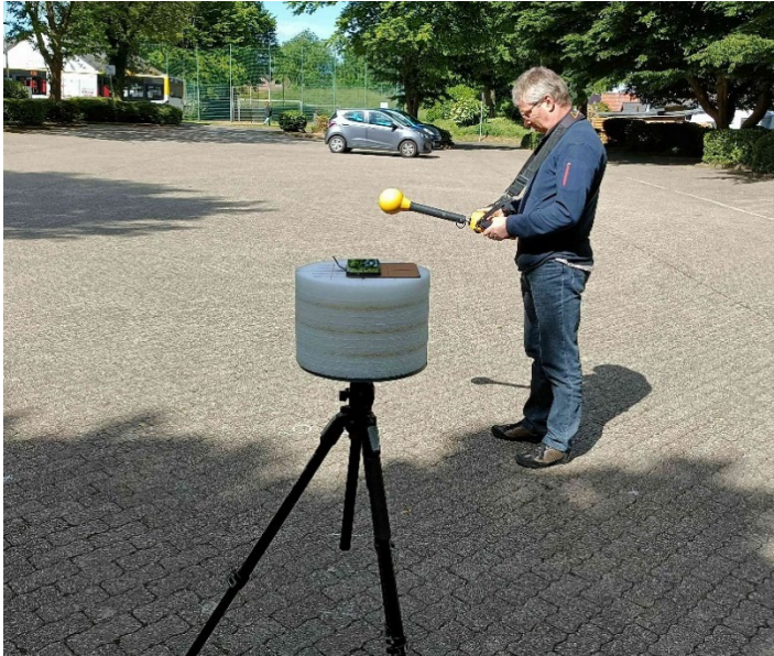
Abbildung 5.1: Positionierung des Mobiltelefons auf einem Stativ mit einer nichtmetallischen Aufnahme (links) und Winkeleinteilung für die Abstrahlcharakteristik (rechts). Im Beispielbild links erfolgt die Messung in Richtung 0°.
