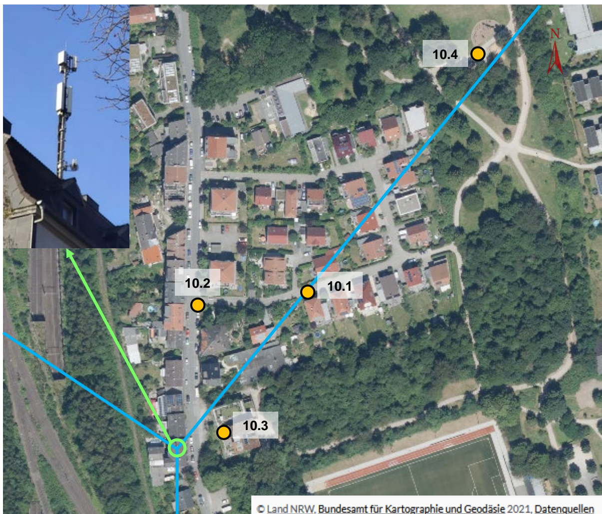
Abbildung 3.10: Ausrichtung der 5G-Sendeanntenen und Lage der Messpunkte am Standort 10. Die blauen Linien stellen die horizontale Antennenausrichtung der 5G-Antennen dar, der grüne Kreis den Standort der Basisstation und die gelb ausgefüllten Kreise die Messpunkte.
