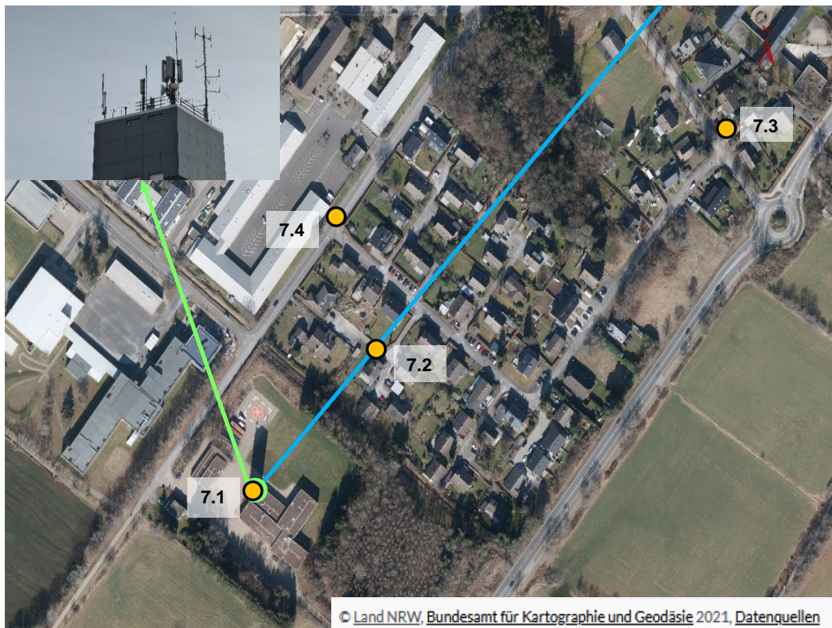
Abbildung 3.7: Ausrichtung der 5G-Sendeannten und Lage der Messpunkte am Standort 7. Die blauen Linien stellen die horizontale Antennenausrichtung der 5G-Antennen dar, der grüne Kreis den Standort der Basisstation und die gelb ausgefüllten Kreise die Messpunkte.
