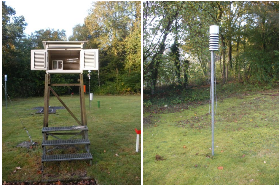
Abbildung 12: Wetterhütte mit Thermohygrograph und Extremthermometer (links), Thermo-Hygrogeber (seit 2006) (rechts)
