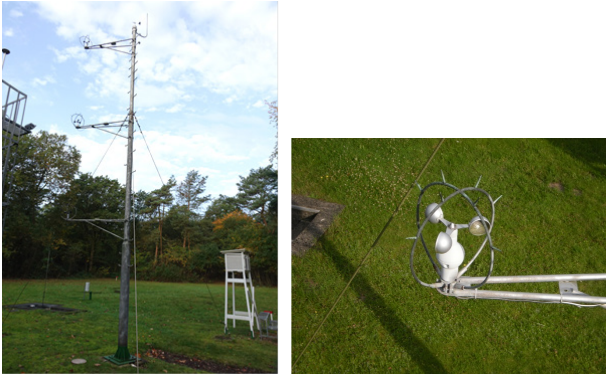
Abbildung 15: Windmast, im Hintergrund die Wetterhütte (links), Kontaktanemometer am Windmast (rechts)
