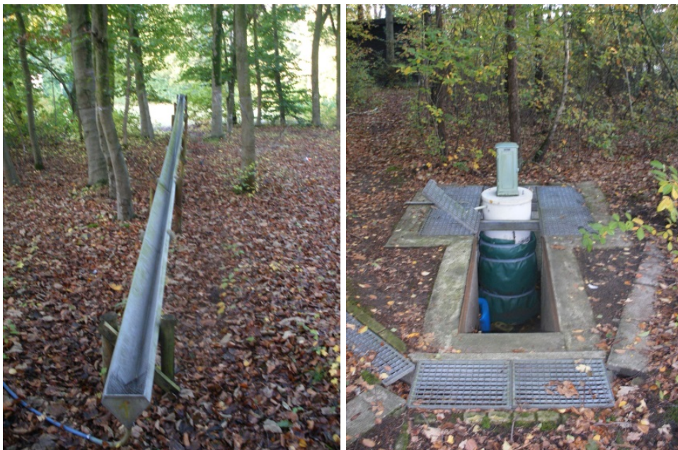
Abbildung 10: Auffangwanne für durchtropfenden Niederschlag unter Wald (links), Sammeltonne und Schreibpegel für durchtropfenden Niederschlag unter Wald (rechts)
