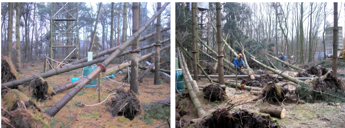
Abbildung 20: Zerstörte Messeinrichtung für Stammablauf (links), Aufräumarbeiten am Lysimeter 3 (rechts)
