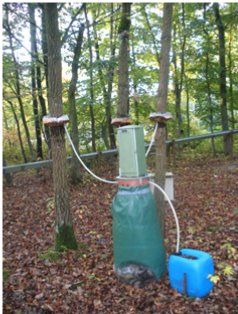
Abbildung 11: Gummimanschetten an den Baumstämmen und Sammeltonne mit Schreibpegel für stammablaufenden Niederschlag unter Wald
