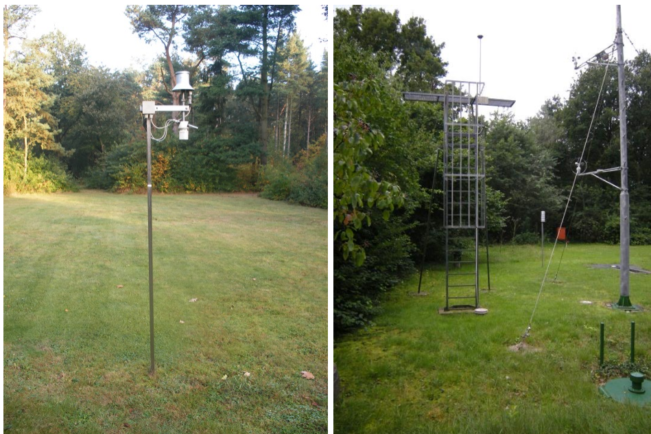
Abbildung 13: Psychrometer nach Frankenberger (1998 bis 2009) (links), Messgerüst mit Pyranometer (seit 1998) (rechts)
