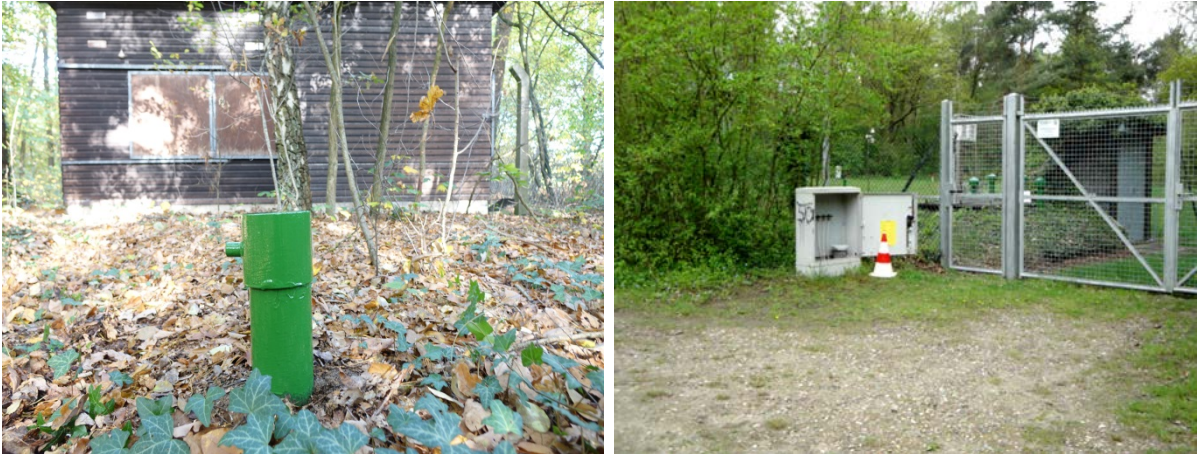
Abbildung 17: Grundwassermessstelle VII/38 LYS.ST.ARND. am Modellhaus (links), Grundwassermessstelle VII/50_ST.ARNOLD am Eingang der Lysimeteranlage (rechts)
