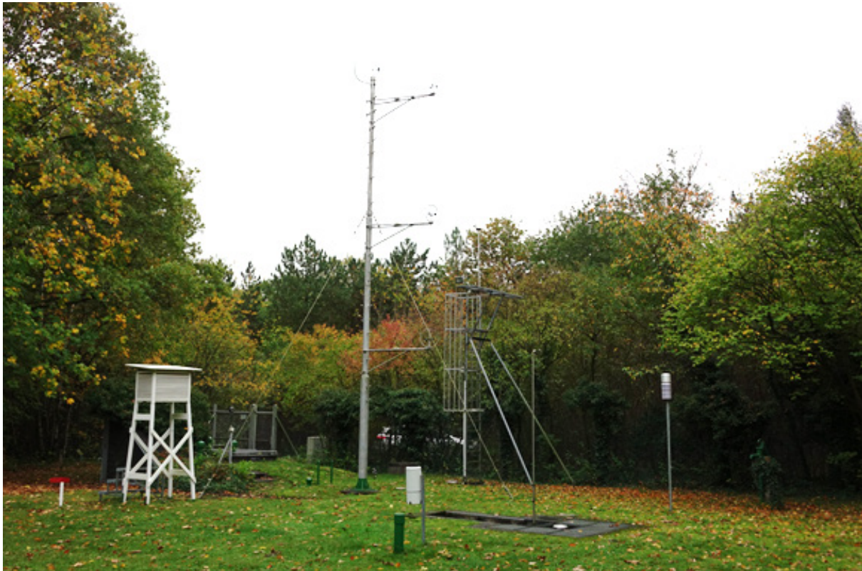
Abbildung 7: Messgeräte-Gesamtansicht (von links nach rechts: Sonnenschreiber, Wetterhütte, Windmast, Pyranometer-Messgerüst, Hellmann-Regenmesser, Thermo-Hygrogeber)
