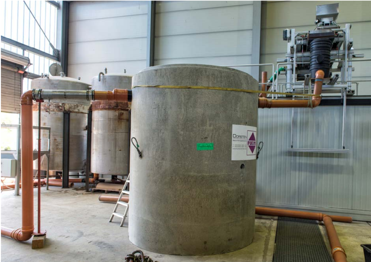
Abb. 1: Der aufgebaute Lamellenklärer Agilex DN 2000; Typ LFA-R-18/1.200 im IKT-Versuchsstand.
