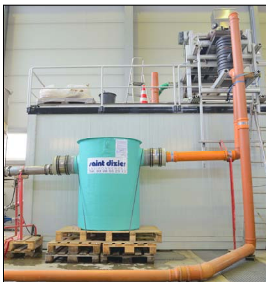
Abb. 2: Stoppol 10 C während der Prüfung im IKT – Institut für Unterirdische Infrastruktur.
