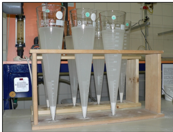
Abbildung 5: Sedimentiertes \text{CaCO}_3 im Imhofftrichter
