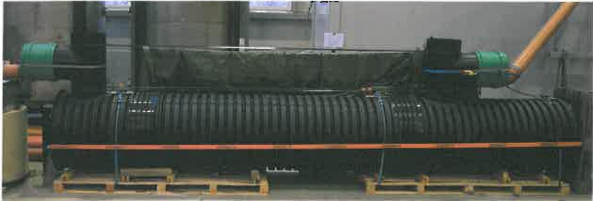
Abb. 1: Die aufgebaute Sedimentationsanlage im IKT-Versuchsstand.
