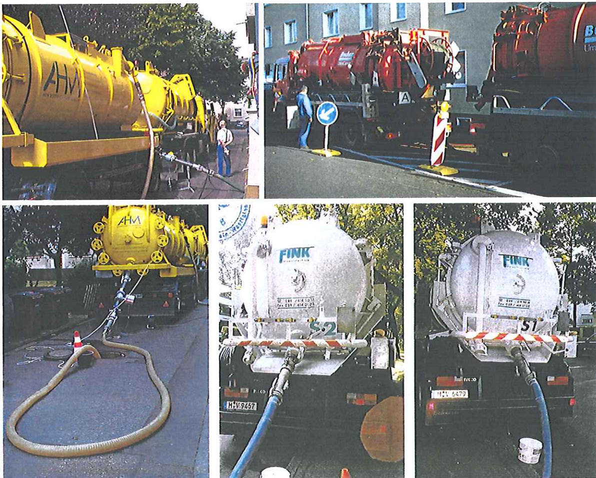
Abbildung 5.3: Saugfahrzeuge mit Injektionsflüssigkeiten
