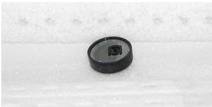
Abbildung 20: Transponder im Klimaschrank [FITR]
