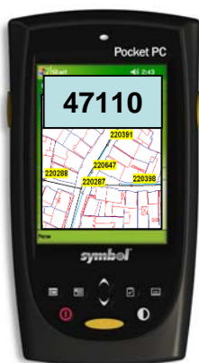
Abbildung 18: PDA mit Identifikationsnummer und Kartenausschnitt [RST]
