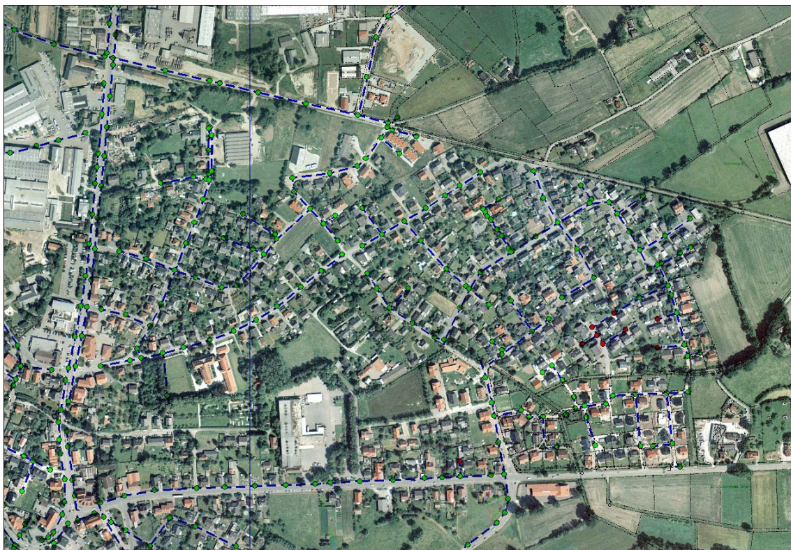
Abbildung 38: Überstau im RW-Kanalsystem [IB Boll]
