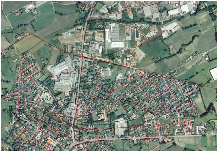
Abbildung 39: SW-Kanalsystem [IB Boll]
