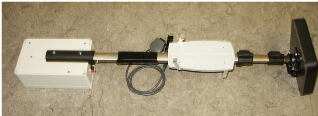
Abbildung 17: Funktionsmuster eines Transponderlesegerätes [RST]
