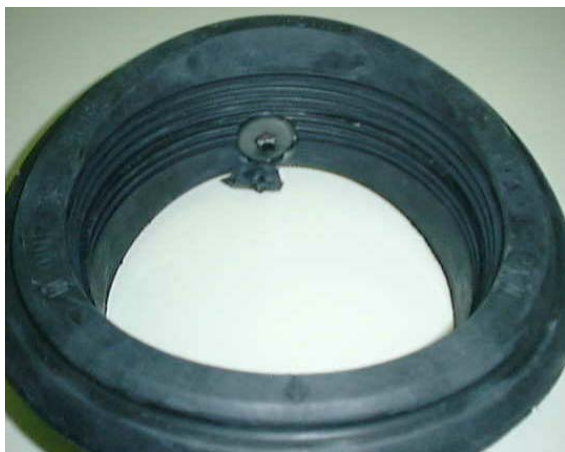
Abbildung 27: Prototyp Dichtung, Einbau innen [FITR]
