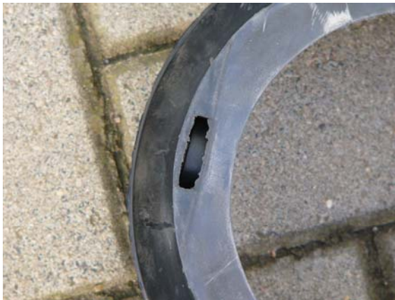
Abbildung 29: Dichtung mit Transponder [FITR]
