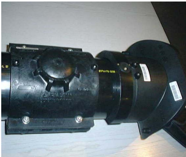
Abbildung 49: geschraubte Manschette mit Datenträger [FITR]
