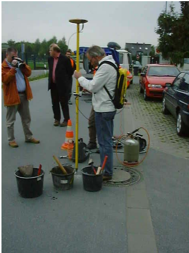
Abbildung 48: GPS-Einmessung eines Transponders [FITR]
