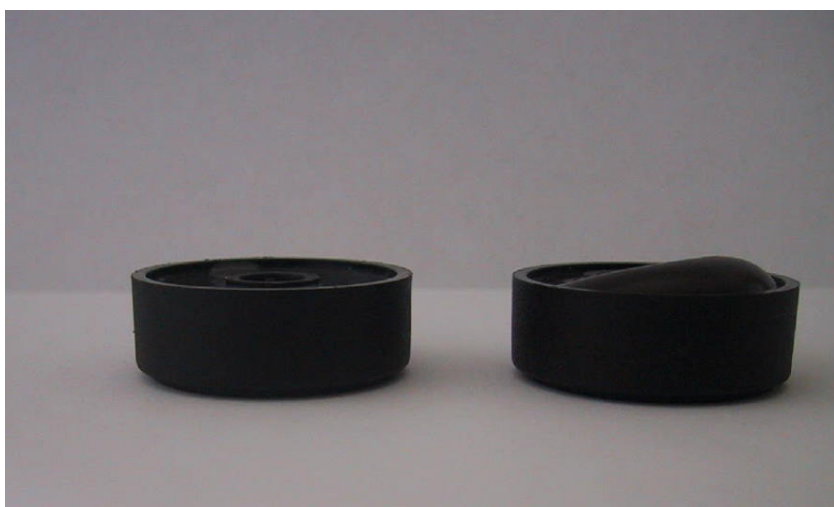
Abbildung 34: Transponder vor und nach einer Temperaturbelastung von 185 °C (v.l.n.r) [FITR]
