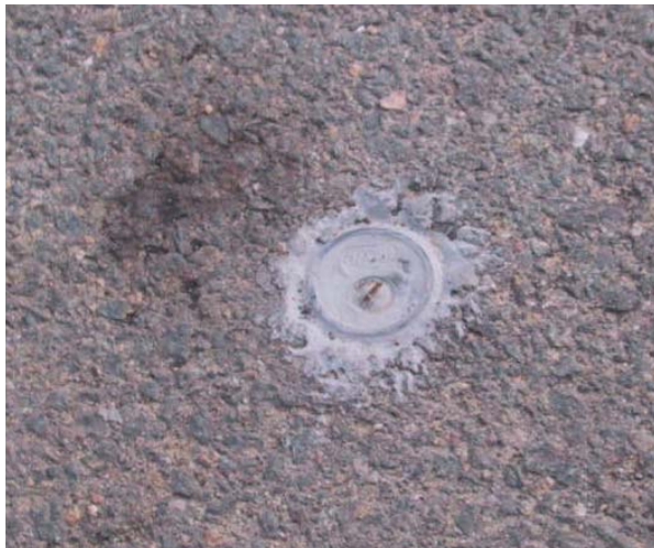
Abbildung 22: oberflächengleicher Einbau Abbildung 23: Temperaturmessung [FITR] [FITR]
