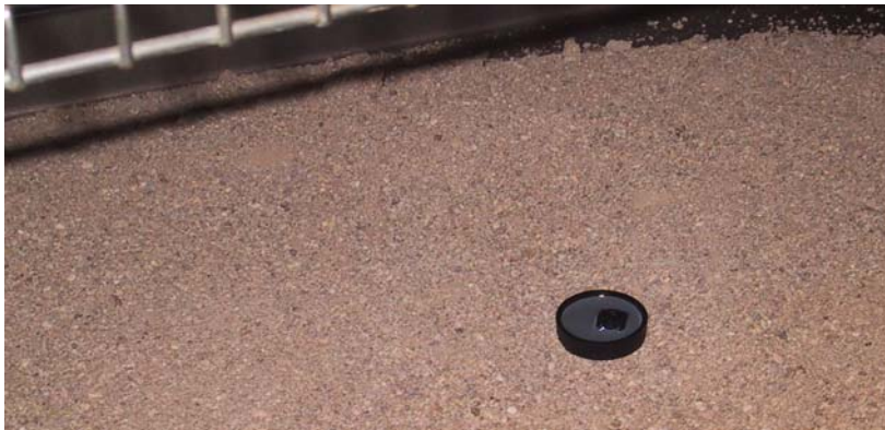
Abbildung 19: Transponder während einer Temperaturprüfung [FITR]
