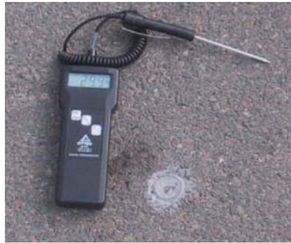
Abbildung 22: oberflächengleicher Einbau Abbildung 23: Temperaturmessung [FITR] [FITR]
