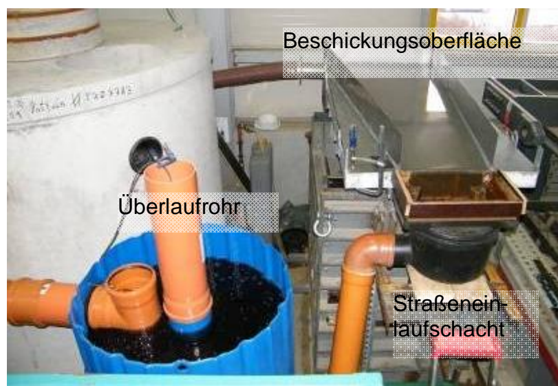
Abbildung 29: Versuchsaufbau 3P Hydrosystem 1000 heavy traffic.
