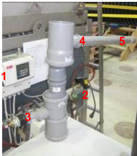
Abbildung 17: Aufbau zur Ermittlung des Rückhalts von Schwermetallen (hier INNOLET ® ) an einem Filterabschnitt (Versuchsanlage 2).
