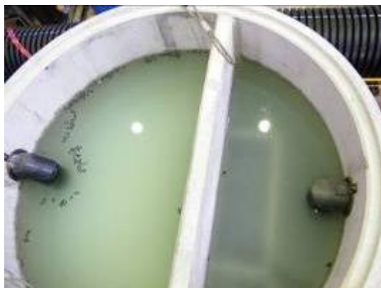
Abbildung 37: Blick von oben in den Lamellenklärer mit deutlichem Unterschied der Trübungen in den zwei Kammern während der Teilprüfung 1. In der Zulaufkammer sind noch die zurückgehaltenen PE-Granulate (schwarz) auf der Wasseroberfläche sichtbar.
