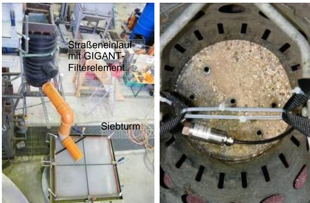
Abbildung 33: Links: Versuchsaufbau Geotextil-Filtersack zur stofflichen Untersuchung (Kies-Sand/Schwebstoffe). Rechts: Rückstand im Grobschmutzfang vor dem Geotextil-Filtersack (Kies-Sand-Gemisch).
