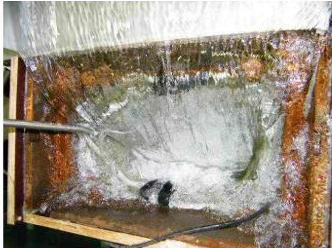
Abbildung 19: Beschickung des Geotextil-Filtersacks mit einem Volumenstrom von 20 l/s (kein hydraulisches Versagen erkennbar).
