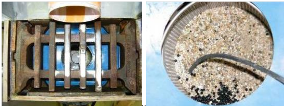
Abbildung 38: Links: Rückstände von MILLISIL nach den Versuchen mit feinkörnigen AFS; nach Entfernen des Plexiglas-Aufsatzes. Rechts: Im Grobschmutzfang zurückgehaltenes Material nach den stofflichen Untersuchungen bzgl. grobkörniger AFS.
