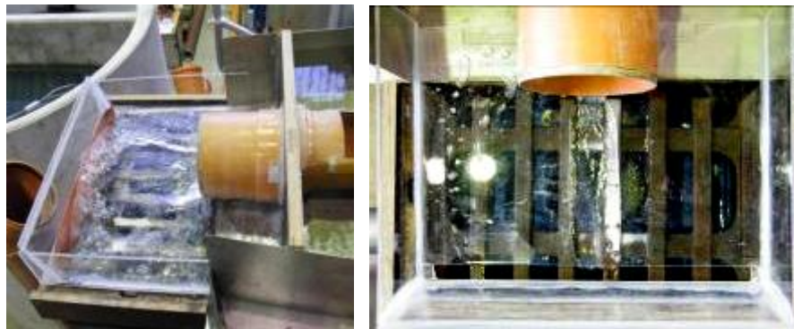
Abbildung 7: Aufsatz aus Plexiglas zur gleichmäßigen Einleitung in den Straßeneinlaufschacht; Links: Aufsatz beim Ausspülversuch mit dem System INNOLET ® und 100 l/(s*ha); Rechts: Draufsicht auf den Aufsatz bei dem Teilversuch 1 mit dem System INNOLET ® und 2,5 l/(s*ha).
