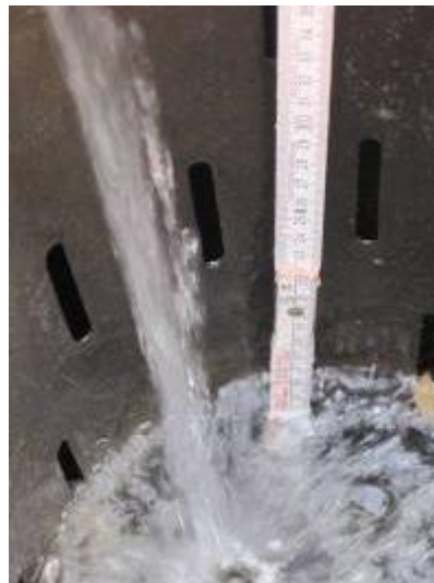
Abbildung 57: Kontrolle des Wasserstandes im Straßenablauf mittels Gliedermaßstab zur Bestimmung der hydraulischen Leistungsfähigkeit während der In-situ-Untersuchungen.
