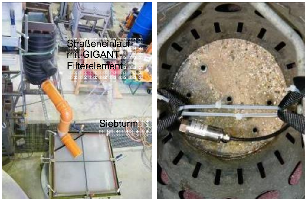
Abbildung 36: Links: Versuchsaufbau Geotextil-Filtersack zur stofflichen Untersuchung (Kies-Sand/Schwebstoffe). Rechts: Rückstand im Grobschmutzfang vor dem Geotextil-Filtersack (Kies-Sand-Gemisch).
