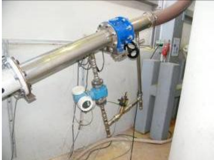
Abbildung 4: Bypassleitung DN 25 mit MID DN 25 und Proportionalventil zur Regelung der Durchflussmengen bis 3 l/s; Absperrklappe DN 150 als Absperrung hinter dem Eingang der Bypassleitung.
