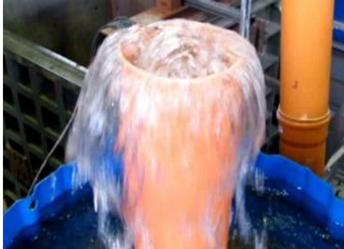
Abbildung 32: Austritt von Wasser aus dem Überlaufrohr bei einer Beschickungsmenge größer als 13,5 l/s.
