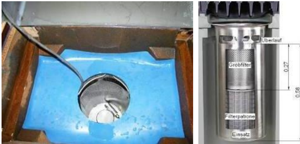
Abbildung 27: Links: Blick von oben in den Grobfilter des INNOLET® mit Adapterplatte (blau) und positionierter Drucksonde. Rechts: Aufbau INNOLET® (Quelle: Funke Kunststoffe GmbH, verändert).
