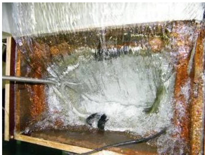
Abbildung 15: Beschickung des Geotextil-Filtersacks mit 20 l/s (kein hydraulisches Versagen erkennbar).
