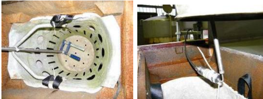
Abbildung 14: Links: Haltestange fixiert am Schmutzfang; Rechts: Wasserstandssensor unterhalb des Schmutzfangbodens.
