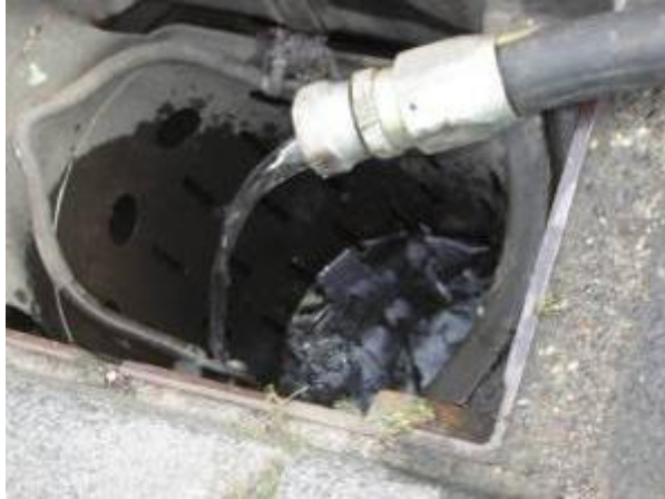
Abbildung 56: Direkte Beschickung eines Straßenablaufs mit einem definierten Volumenstrom zur Bestimmung der hydraulischen Leistungsfähigkeit einer Niederschlagswasserbehandlungsanlage
