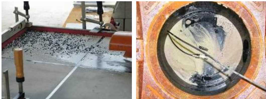
Abbildung 38: Links: Rückstand auf dem obersten Sieb nach Teilprüfung 1. Rechts: Blick von oben in die obere Kammer des Centrifoeel® nach der Teilprüfung 1 (Kies-Sand/Schwebstoffe).
