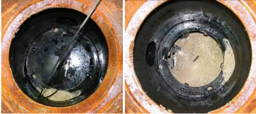
Abbildung 39: Blick von oben in den Centrifoeel® nach dem Ausspülversuch. Links: obere Kammer; Rechts: mittlere Kammer.
