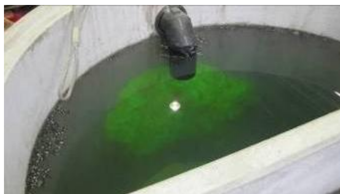
Abbildung 41: Schockinjektion des Tracers Uranin zur Bestimmung der Durchlaufzeit des MLK-R 20/9.
