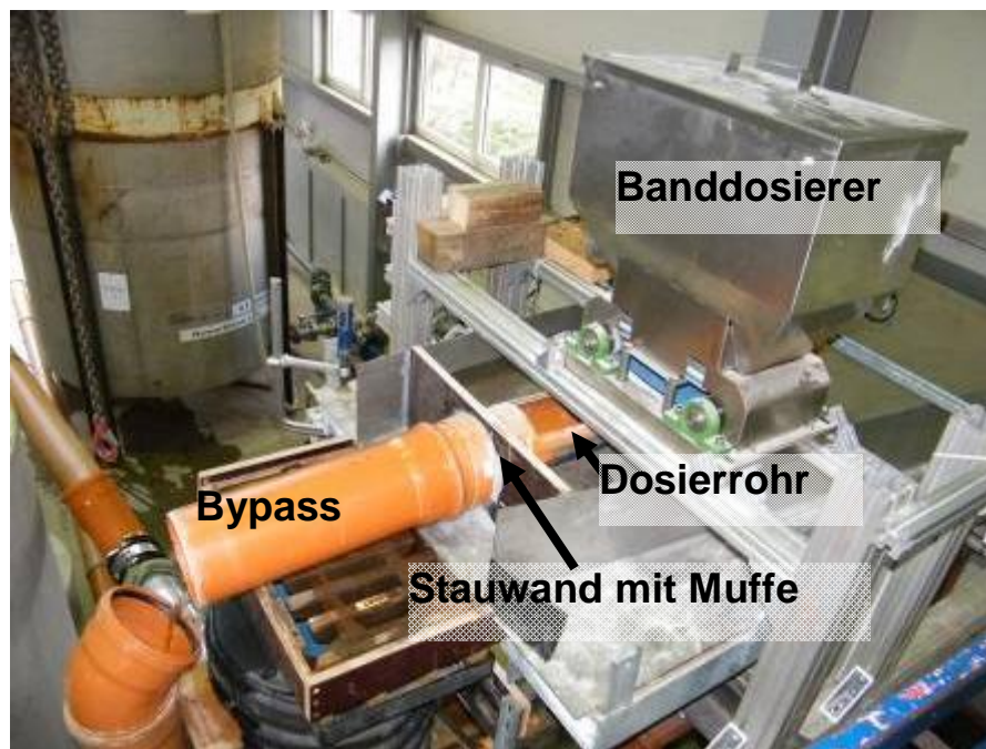
Abbildung 6: Ansicht der Dosiereinrichtung für feinkörnigen AFS.
