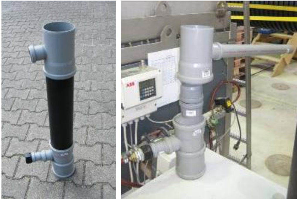
Abbildung 50: Links: Säule zur Ermittlung des Rückhalts von Schwermetallen (3P Hydrosystem). Rechts: Säule zur Ermittlung des Rückhalts von Schwermetallen (INNOLET®) eingebaut in der Versuchseinrichtung 2.
