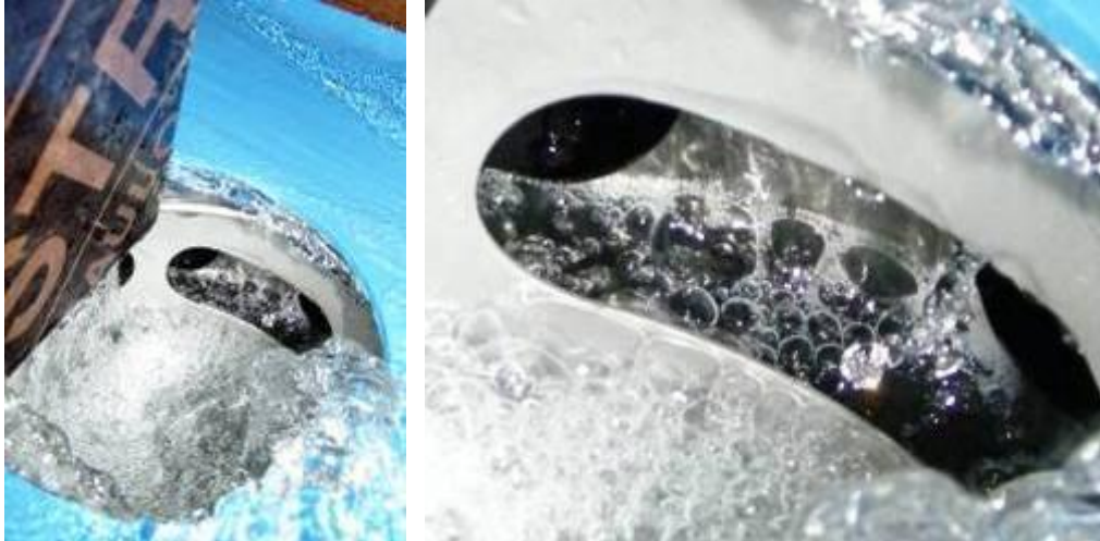
Abbildung 28: Links: Blick in den INNOLET® von oben bei einem Volumenstrom von 1,5 l/s. Rechts: Detailansicht, Überlauf angesprungen.
