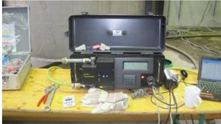
Abbildung 42: Fluoreszenzspektrometer zur Bestimmung des Konzentrationsverlaufs im Ablauf des MLK-R 20/9.
