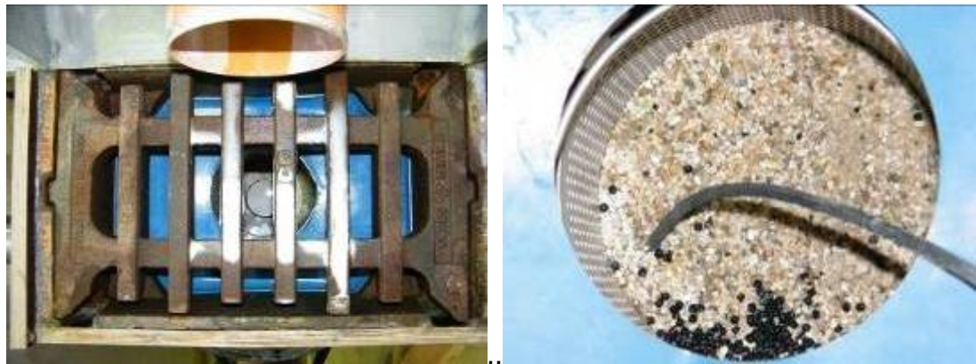
Abbildung 46: Links: Rückstände von MILLISIL nach den Versuchen mit feinkörnigen AFS; nach Entfernen des Plexiglas-Aufsatzes. Rechts: Im Grobschmutzfang zurückgehaltenes Material nach den stofflichen Untersuchungen grobkörniger AFS.
