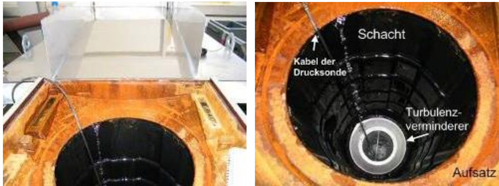
Abbildung 21: Links: Anschluss an die Versuchsanlage. Rechts: Draufsicht des eingebauten Separationsstraßenablauf SSA.
