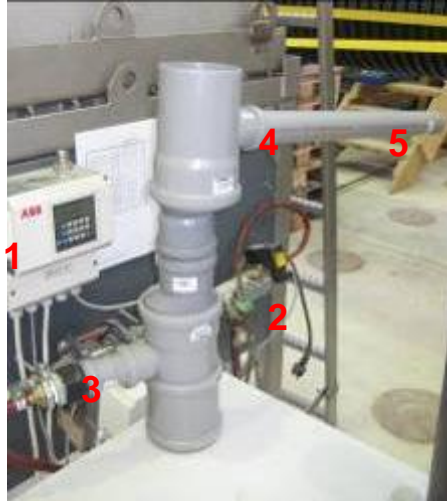
Abbildung 10: Aufbau zur Ermittlung des Rückhalts von Schwermetallen (hier INNOLET®) an einem Filterabschnitt (Versuchseinrichtung 2).
