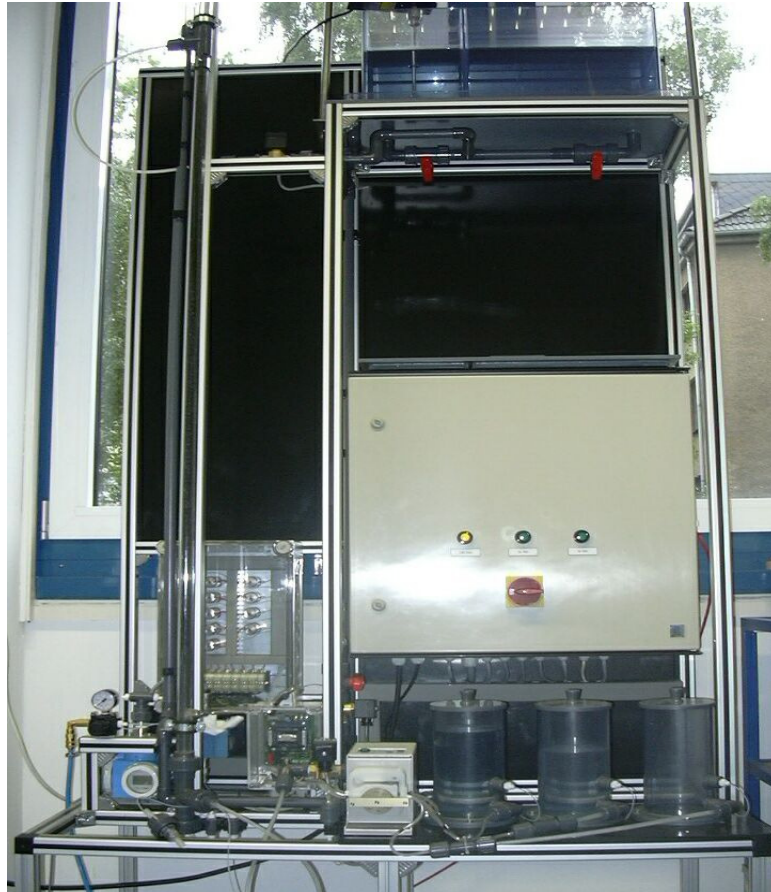
Abb. 3-11: Laboranlage für den Betrieb von getauchten Einzelkapillaren
