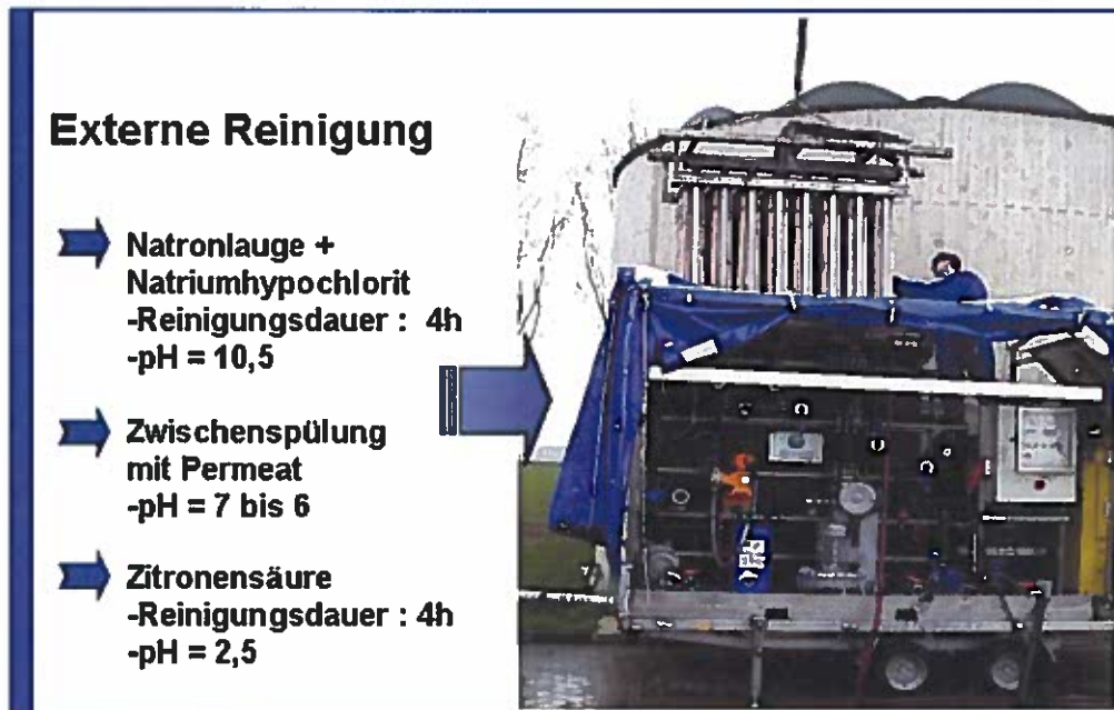
Abb. 4-6: Reinigung in externer Waschanlage
