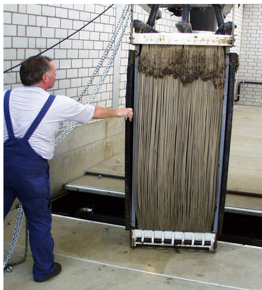
Abb. 1-2 : Membranmodul nach 5-monatigem Betrieb.
