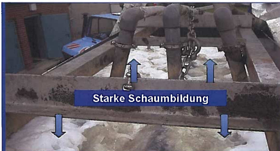
Abb. 4-9: Schaumbildung bei der Reinigung mit enz. Reinigungsmittel
