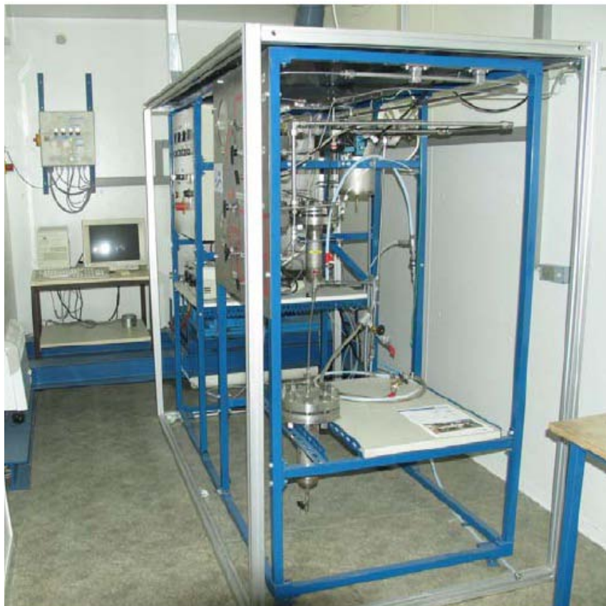
Bild 3-17: Pilotanlage zur Methanolsynthese des ZSW
