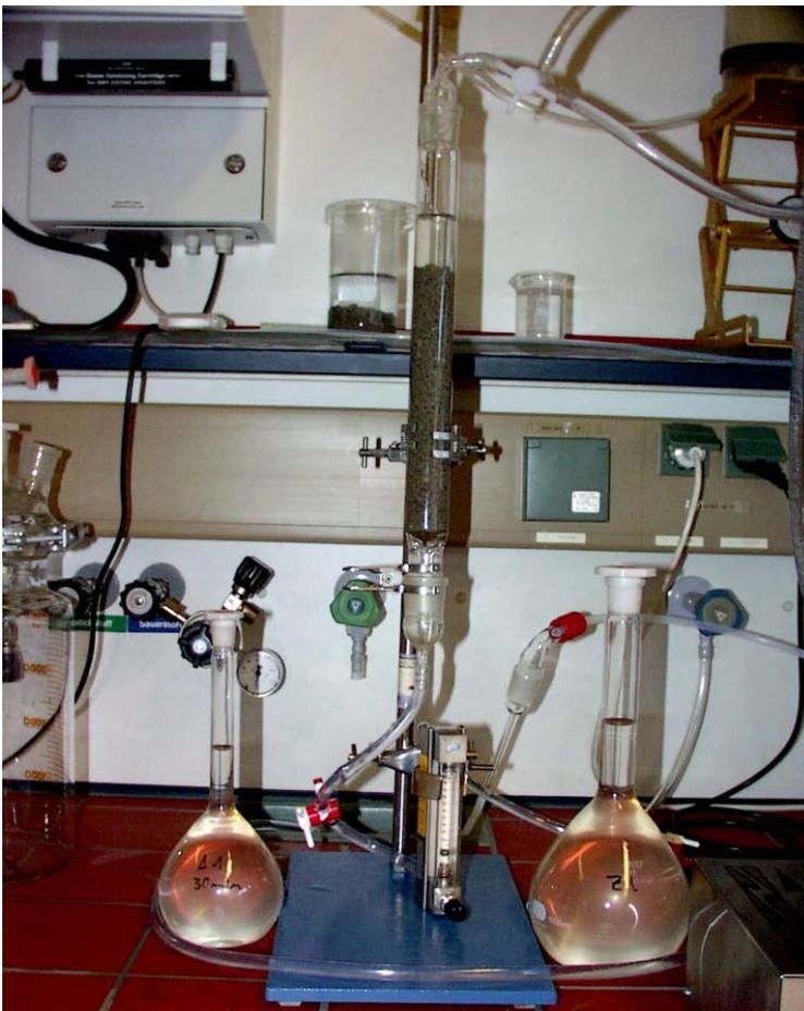
Abbildung 46: Versuchsaufbau zur Überprüfung des Granulats DIAKAT A
