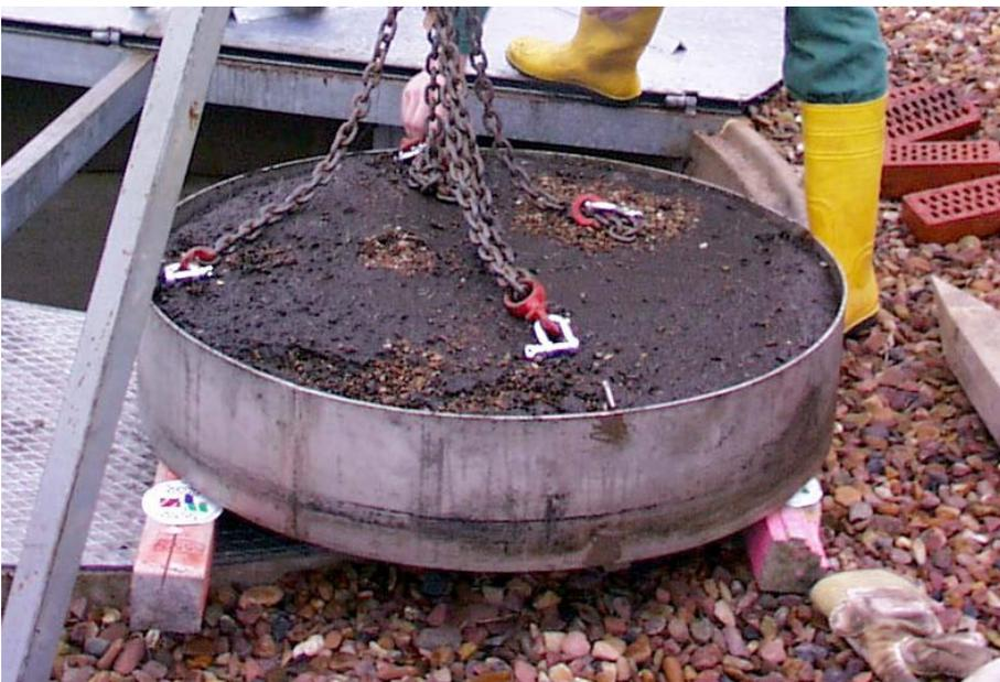
Abbildung 49: Die obere Kiesschüttung nach der Entnahme aus dem Schacht
