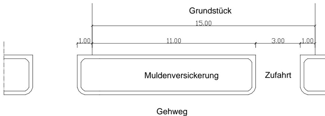
Abbildung 57: Lageplanskizze der Muldenversickerung
