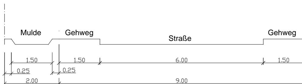
Abbildung 56: Regelquerschnitt der Muldenversickerung
