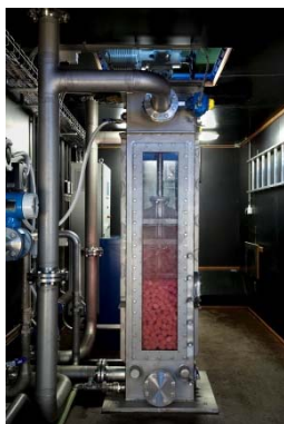
Testcontainer mit Fuzzy Filter Typ 1 für Pilotversuche (Foto: Bosman Watermanagement GmbH)
