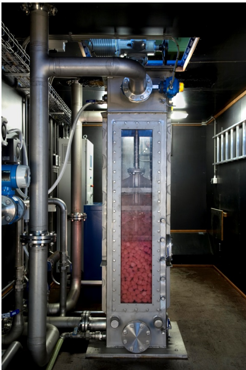
Abbildung 4-8: Testcontainer mit Fuzzy Filter Typ 1 für Pilotversuche (Foto: Bosman Watermanagement GmbH)
