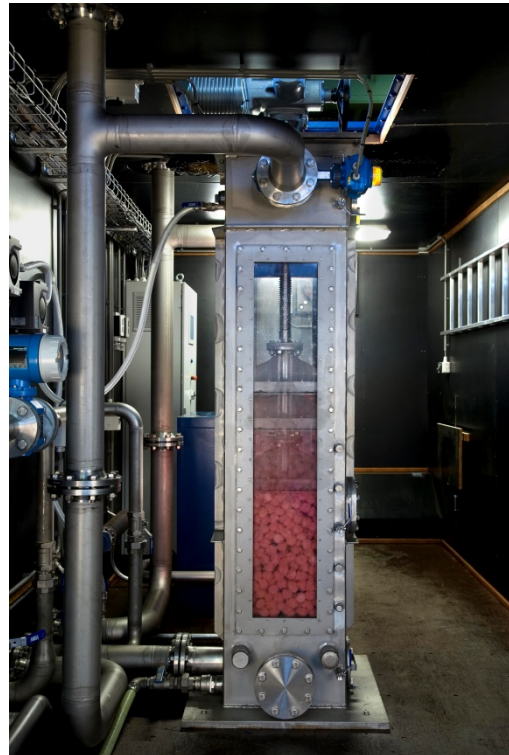
Abbildung 1: Testcontainer mit Fuzzy Filter Typ 1 für Pilotversuche (Foto: Bosman Watermanagement GmbH)
