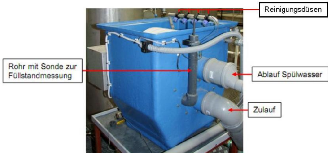
Abbildung 6.23: Mikrosiebanlage (verändert nach Pinnekamp, 2012)
