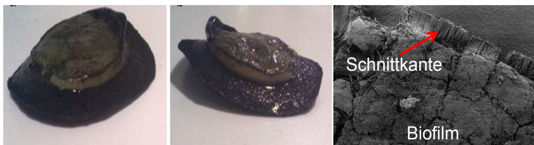
Abbildung 40: Ansichten des Biofilms auf der Kathodenoberfläche der Einkammer-Glas-MBZ.
