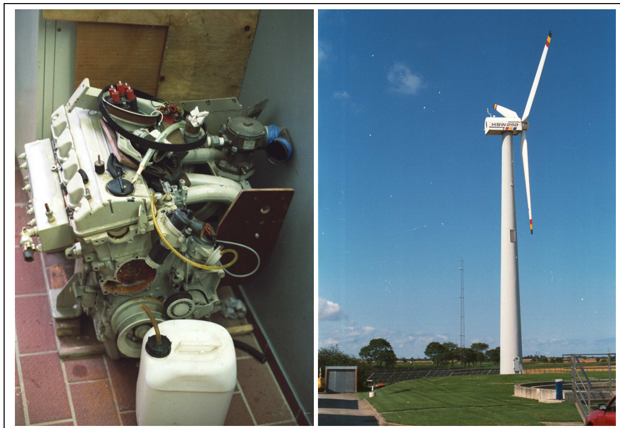
Abbildung 24: Foto des defekten BHKW-Moduls (links) sowie der Windkraftanlage (rechts) der Kläranlage Burg auf Fehmarn
