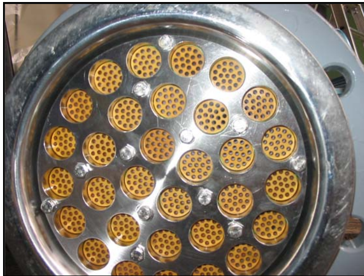
Abbildung 4-51: Keramisches UF-Modul zur Behandlung des Emulsionsabwassers (Fa. Atech)
