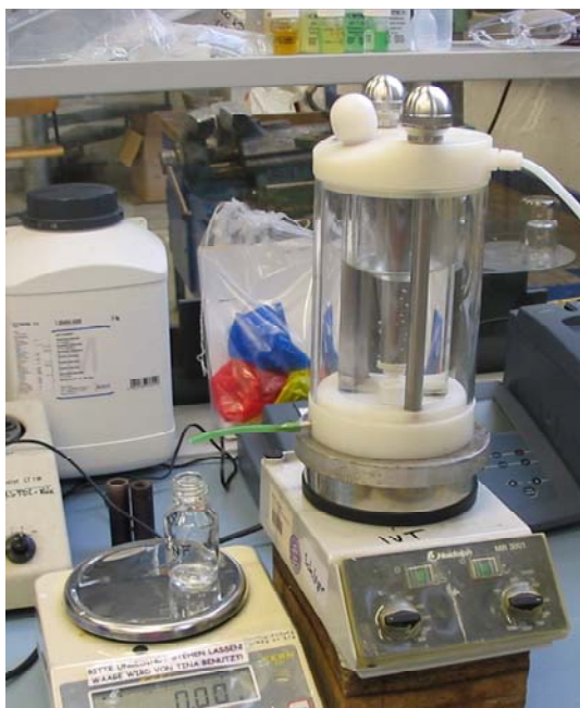
Abbildung 4-1: Niederdruckzelle GN-400 und Funktionsprinzip der Niederdruckzelle
