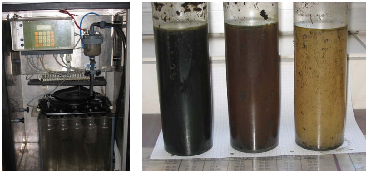
Abbildung 2-4: Probenehmer und 8 h-Mischproben des Emulsionsabwassers von 3 verschiedenen Tagen
