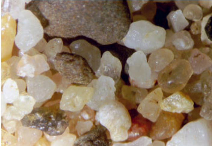
Bild 3.5: Aufnahme des Rheinsandes 0/4 mm
