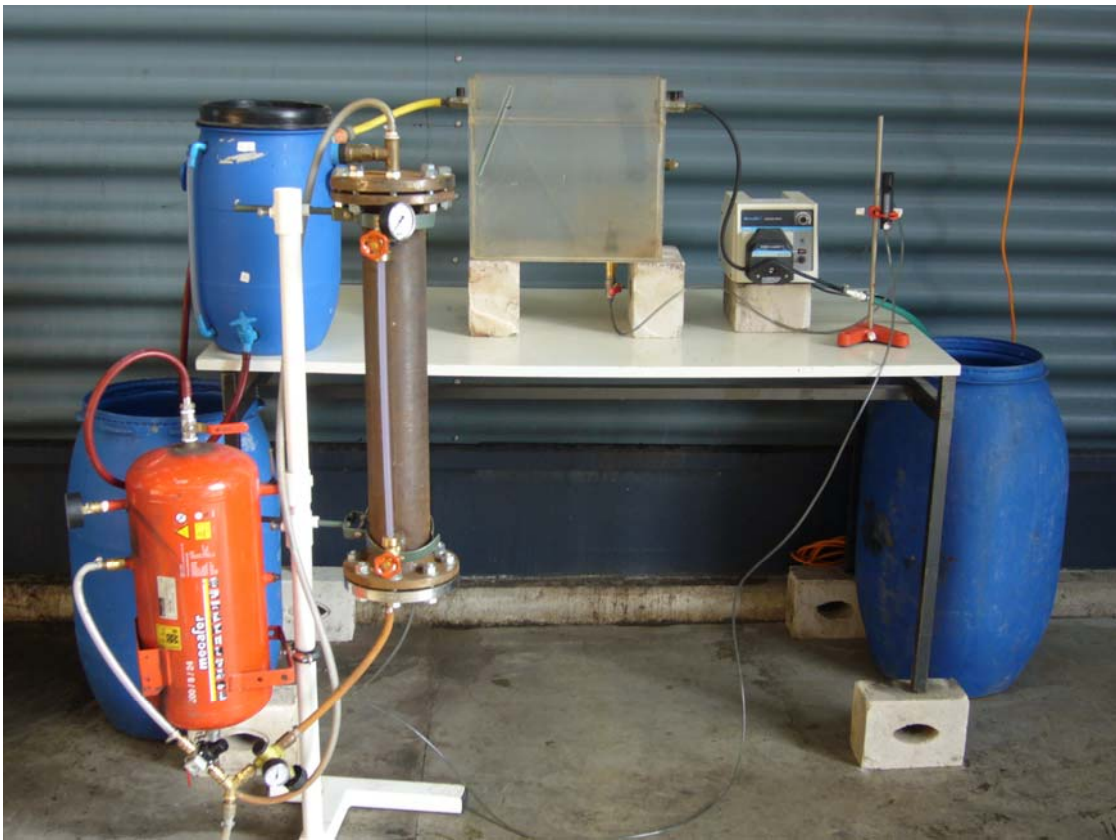
Abb. 5-1: Aufbau der Sedimentation-Flotation-Versuchsanlage
