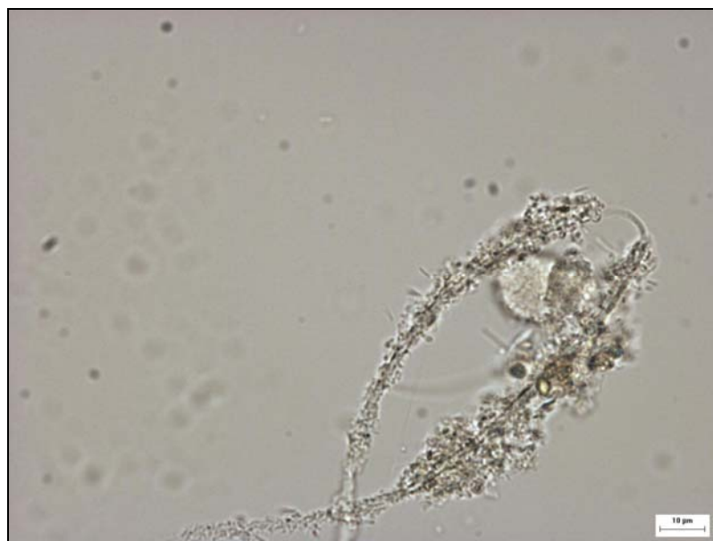
Abbildung 8-15: Belebtschlammprobe KA Brenzingen: Typ 1701 im Nativpräparat mit deutlichem Aufwuchs und erkennbarer Scheide, Hellfeldmikroskopische Aufnahme (1.000fache Vergrößerung)
