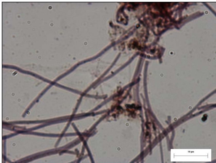
Abbildung 8-16: Belebtschlammprobe MBR: Typ 0092 nach Neisser-Färbung mit deutlich Neisser- positiver Reaktion, Hellfeld-mikroskopische Aufnahme (1.000fache Vergrößerung)
