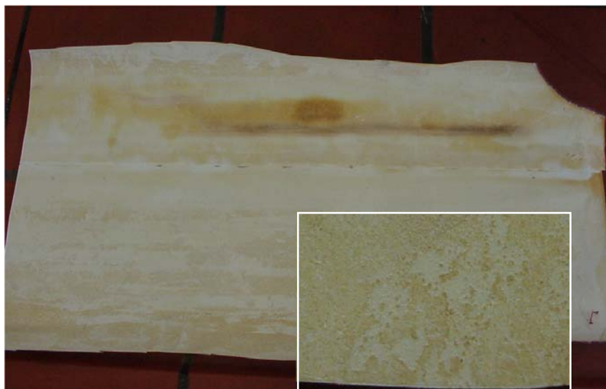
Abb. 16: Membran nach Aufbereitung der realen Abwässer (mit Ausschnittsvergrößerung)
