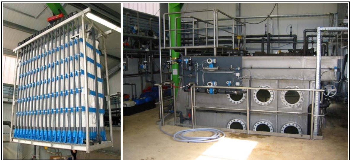
Bild 5-4: externe Filtrationseinheit der Membranversuchsanlage (links: Membranmodul; rechts: Filtrationskammer)
