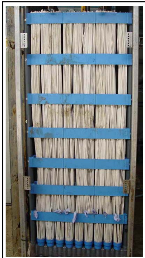
Bild 6-83: Foto einer Reihe mit neuem Luftsystem nach einer Betriebsphase mit Regenwetterfluss
