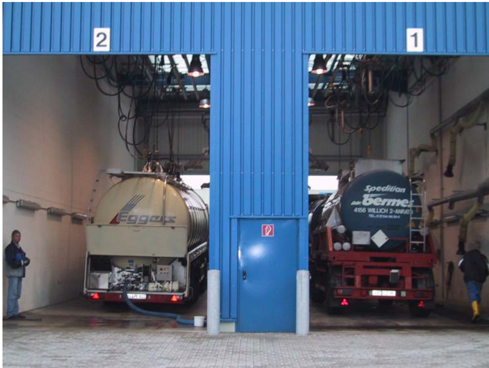
Abbildung 4: Waschstraßen für die Tankinnenreinigung bei der Firma WTR
